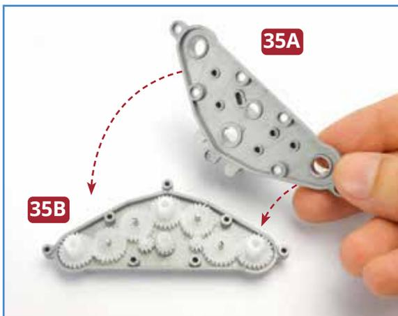
**6** Setzen Sie das Getriebegehäuse **35A** so auf das Getriebe **35B** auf, dass die Wellen und Buchsen der Zahnräder in den entsprechenden Sacklöchern bzw. Löchern des Getriebegehäuses sitzen. Fixieren Sie das Gehäuse mit sieben Schrauben **CP**: Ziehen Sie die einzelnen Schrauben abwechselnd sukzessive an, bis alle schließlich fest sitzen.
