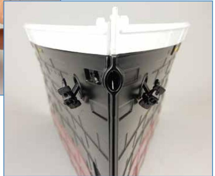
**7** Überprüfen Sie nun die Funktion der Anker, indem Sie sie nach unten ziehen. Wenn die Winde vollständig aufgezogen ist, sollten sich die beiden Anker auf gleicher Höhe befinden. Wenn ein Anker niedriger als der andere ist, müssen Sie die Länge anpassen, indem Sie die Spange **40J** durch verschiedene Glieder der Ketten **40I** und **24B** stecken.
