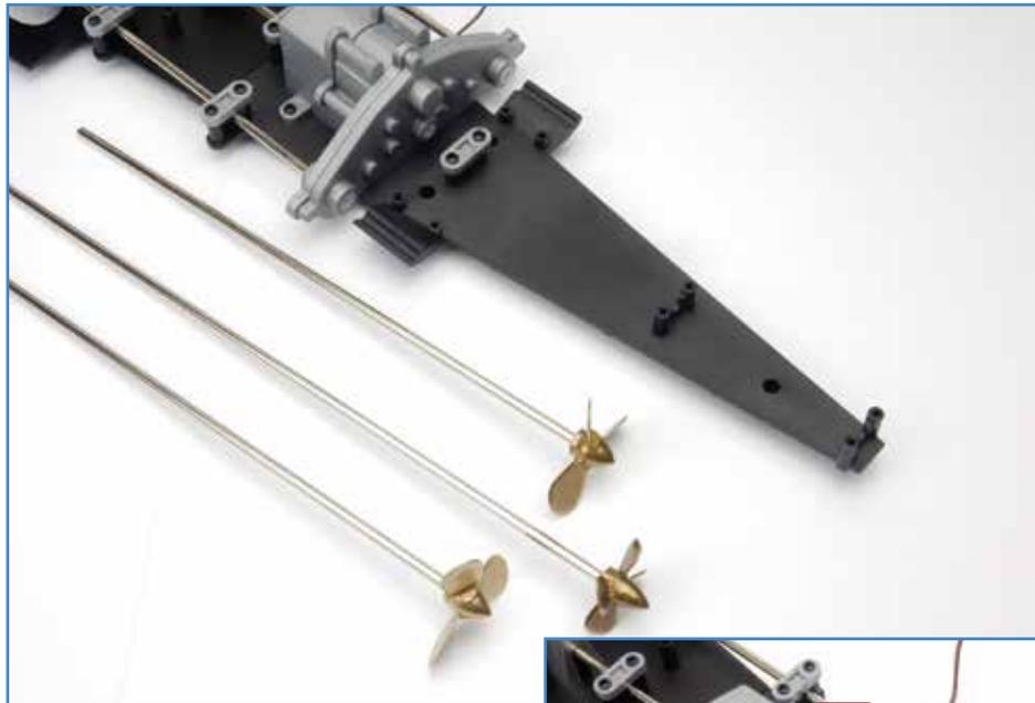
**2** Legen Sie die große Maschinen-Baugruppe bereit. Stecken Sie die vorderen Enden der Seitenwellen **40A** in die Buchsen an den äußeren Ecken des Getriebes **35B** (rot eingekreist). Die Mittelwelle **40B** verläuft unter der Führung **39I** und endet im zentralen Loch des Getriebes (blau eingekreist). Verwenden Sie keinen Klebstoff. Die Wellen und Zahnräder des Getriebes müssen sich frei drehen können.
