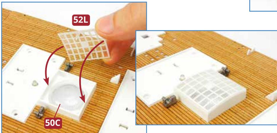
**5** Das Oberlicht **52L** wird im hinteren Bereich des Bootsdecks über der Kuppel **50C** auf dem Deckshaus platziert. Kleben Sie es noch nicht fest. Sie können das Oberlicht aber mit Klebeband provisorisch befestigen.
