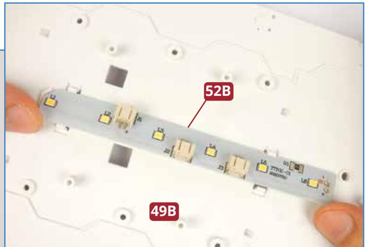
**3** Legen Sie die große Bootsdeck-Baugruppe vorsichtig verkehrt herum auf Ihre Arbeitsplatte. Der LED-Streifen **52B** gehört auf die Unterseite des hinteren Decksabschnitts **49B**. Fügen Sie die eine Längsseite des LED-Streifens unter den Laschen ein und lassen Sie die andere Längsseite einrasten, indem Sie die dortigen Laschen mit einem kleinen flachen Schraubenzieher leicht zur Seite drücken.
