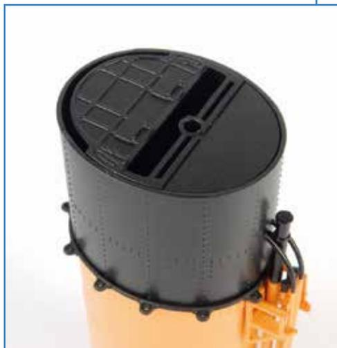
**5** Setzen Sie die Schornsteinkappe **57I** von oben in den Schornstein ein. Anschließend wird die Abdeckung **57K** montiert: Platzieren Sie ihre kleinen Einkerbungen auf den rechteckigen Vorsprüngen an der Innenseite der oberen Verkleidung **57C** (oben, gelb eingekreist). Fixieren Sie die Abdeckung übergangsweise mit etwas Klebeband.
