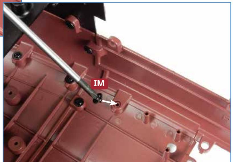
**5** Stellen Sie die Rumpfstruktur bereit. Nehmen Sie den Rumpfabschnitt **65A** und platzieren Sie seine beiden Laschen auf den Aufnahmen des Rumpfabschnitts **21A** und des Kielabschnitts **62A**. Fixieren Sie die Teile **65A** und **21A** mit einer Sechskantschraube **LM** aneinander, die Teile **65A** und **62A** mit einer Schraube **IM**.
