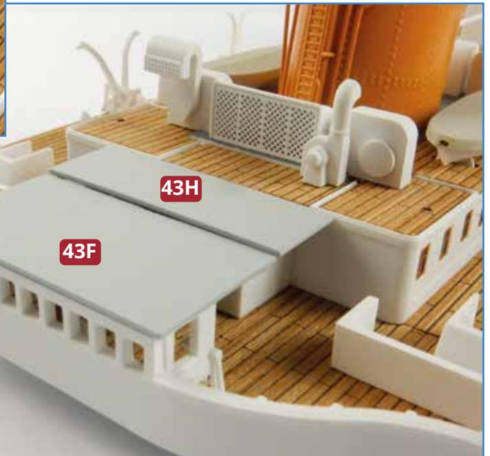
**4** Nehmen Sie die beiden Platten **43F** und **43H** zur Hand. **43H** wird auf dem Ruderhaus aufgesetzt, **43F** auf der Brücke, wie abgebildet. Wir empfehlen, die beiden Teile nicht festzukleben, sodass Sie sie später abnehmen können und einen uneingeschränkten Blick auf das Innenleben haben.
