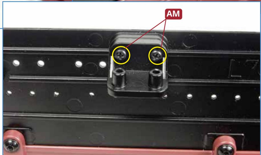
**6** Positionieren Sie den Winkel **65B** auf der Backbordseite der Rumpfstruktur am Abschnitt **64A**. Fixieren Sie die beiden Teile mit zwei Schrauben **AM** aneinander, wie abgebildet.
