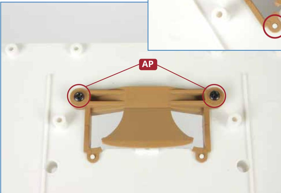
**3** Drehen Sie das Promenaden-deck **69A** auf den Kopf und positionieren Sie die Freitreppe **69B** über dessen Öffnung (oben links). Die Schraubenlöcher der Freitreppe gehören auf die erhabenen Aufnahmen des Decks, die Zapfen an der Decksunterseite werden in die Löcher an der Freitreppe gesteckt (oben, eingekreist). Fixieren Sie die Freitreppe mit zwei Schrauben **AP** (links).
