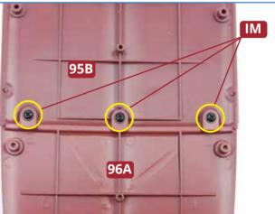
Legen Sie die mit der letzten Ausgabe gelieferte Kiel-Sektion 95B bereit. Nehmen Sie den Kielabschnitt 96A und platzieren Sie die Laschen an dessen vorderem Ende über den drei Aufnahmen an der Hinterkante von 95B. Fixieren Sie die beiden Teile mit drei Schrauben IM aneinander.
