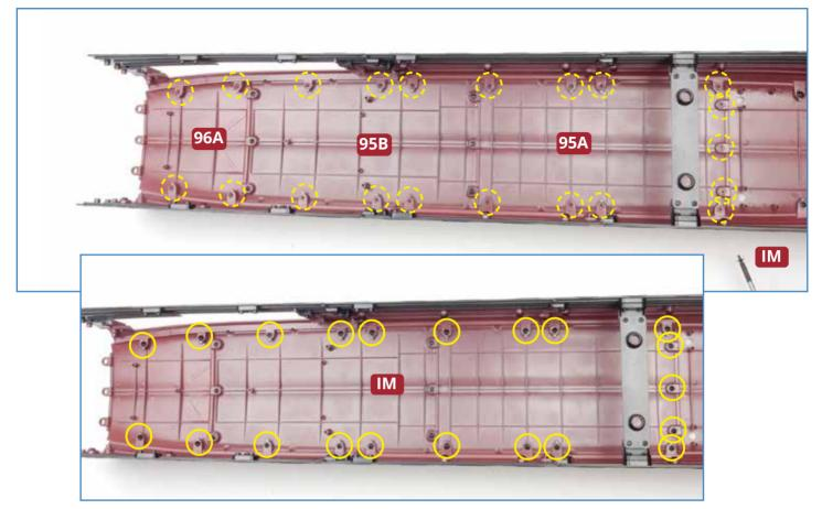
3 Drehen Sie die Rumpfbaugruppe um und halten Sie dabei die Kiel-Sektion in Position. Fixieren Sie beide Baugruppen aneinander, indem Sie insgesamt 21 Schrauben IM eindrehen (im unteren Bild gelb eingekreist, die Schrauben stammen aus Ausgabe 95).
