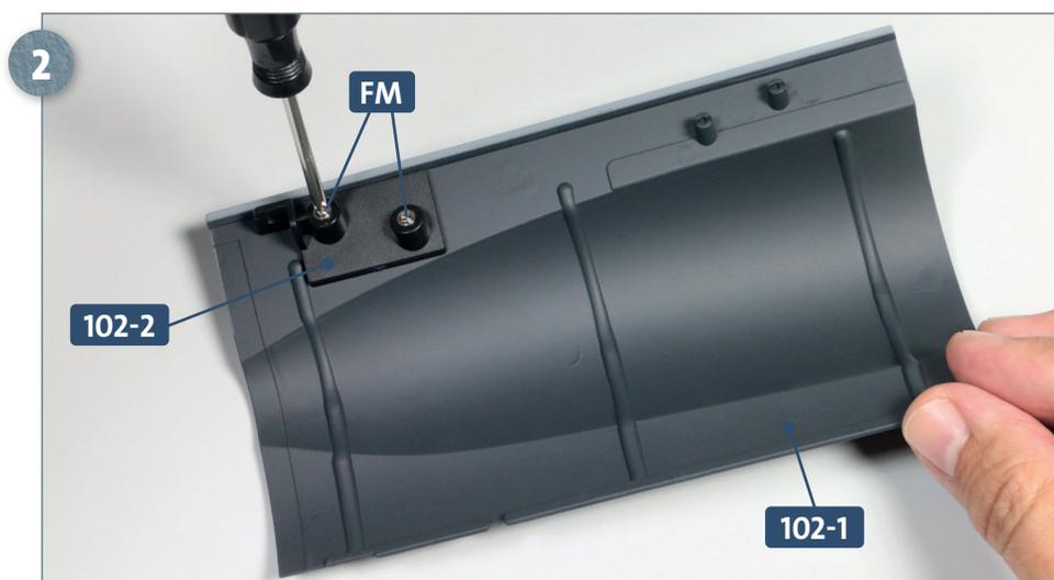
Befestigen Sie den Verbinder **102-2** mit zwei Schrauben **FM** am hinteren Ende des Rumpfabschnitts **102-1**.
