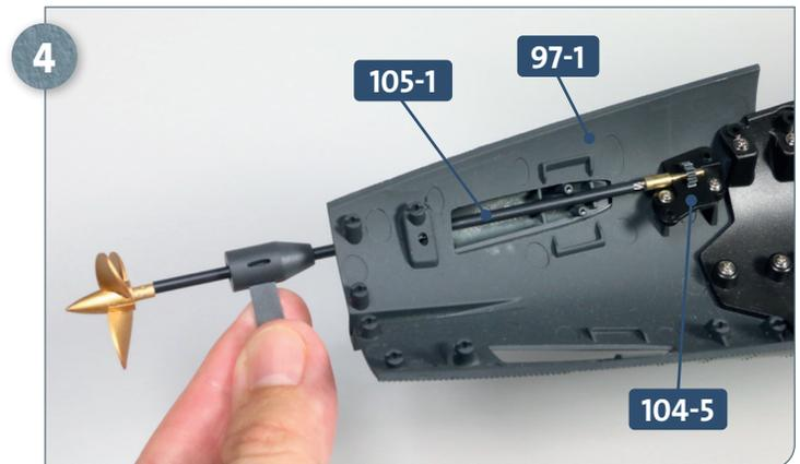
Führen Sie die Welle der Baugruppe **105-1** von hinten durch die längliche Öffnung im Rumpfabschnitt **97-1**. Das Zahnrad am vorderen Wellenende findet in der Aussparung des Motorgehäuses **104-5** seinen Platz, wie abgebildet.
