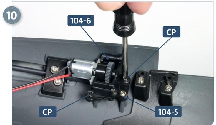
Befestigen Sie die beiden Teile des Motorgehäuses **104-6** und **104-5** aneinander, indem Sie zwei Schrauben **CP** eindrehen.
