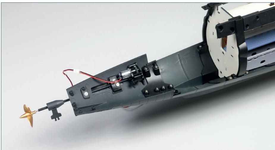
Die Baugruppe mit der linken Propellerwelle ist in die Rumpfstruktur eingefügt und an dieser befestigt. Der Motor für den linken Propeller ist ebenfalls montiert.
