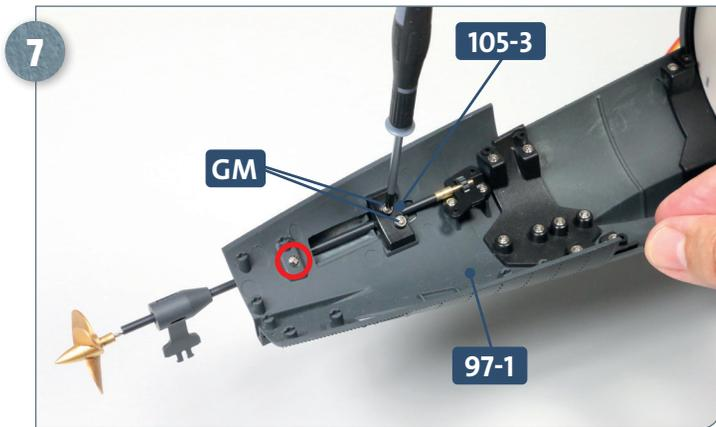
Befestigen Sie die Halteplatte **105-3** mit zwei Schrauben **GM** am Rumpfabschnitt **97-1**. (Rot eingekreist ist die mit Schritt 6 angebrachte Schraube.)
