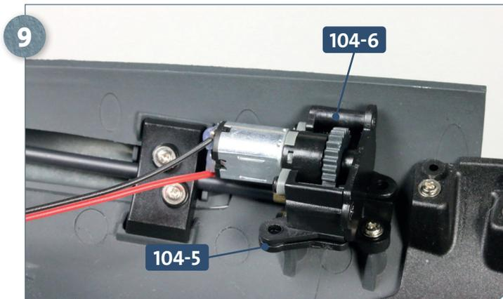
Positionieren Sie das Motorgehäuse **104-6** auf dem bereits am Rumpf befestigten Motorgehäuse **104-5**, wie abgebildet.
