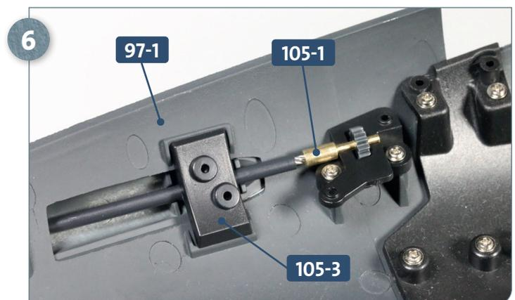
Platzieren Sie die Halteplatte **105-3** in der Aussparung des Rumpfabschnitts **97-1**: Die Platte überdeckt das Wellenrohr von **105-1**, wie es das Foto zeigt.
