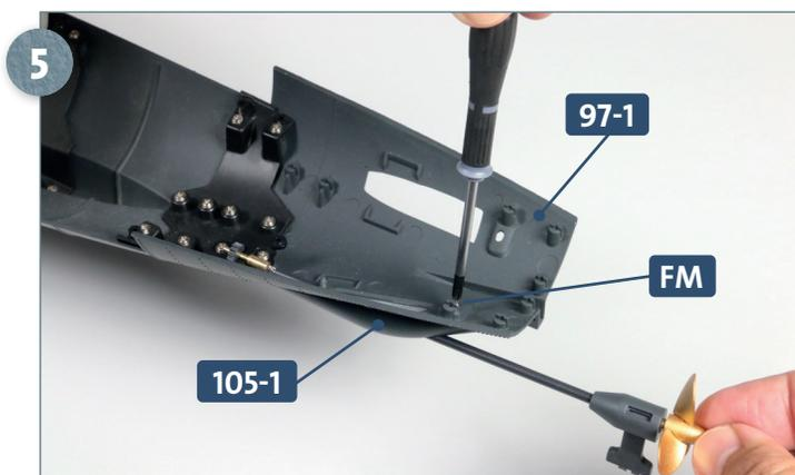
Befestigen Sie die gewölbte Druckguss-Struktur, die sich an der Propellerwellen-Baugruppe **105-1** befindet, mit einer Schraube **FM** an der Rumpfstruktur **97-1**. Die Schraube ist auf dem Foto von Schritt 7 rot eingekreist.
