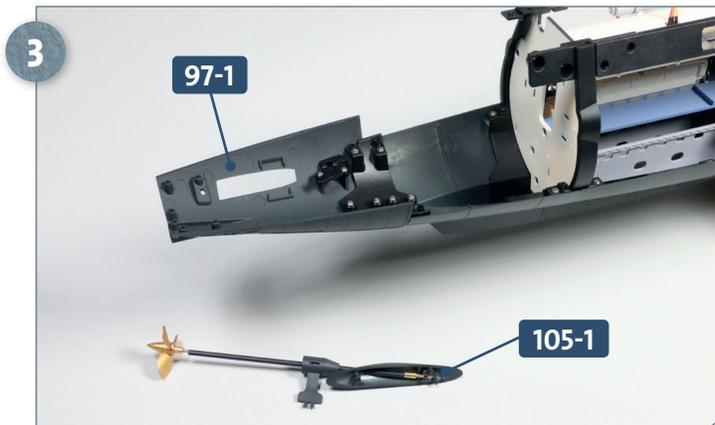
Stellen Sie die Rumpfstruktur so auf Ihre Arbeitsplatte, dass Sie Zugriff auf deren hinteres Ende mit dem Rumpfabschnitt **97-1** haben. Legen Sie die Propellerwellen-Baugruppe **105-1** bereit.
