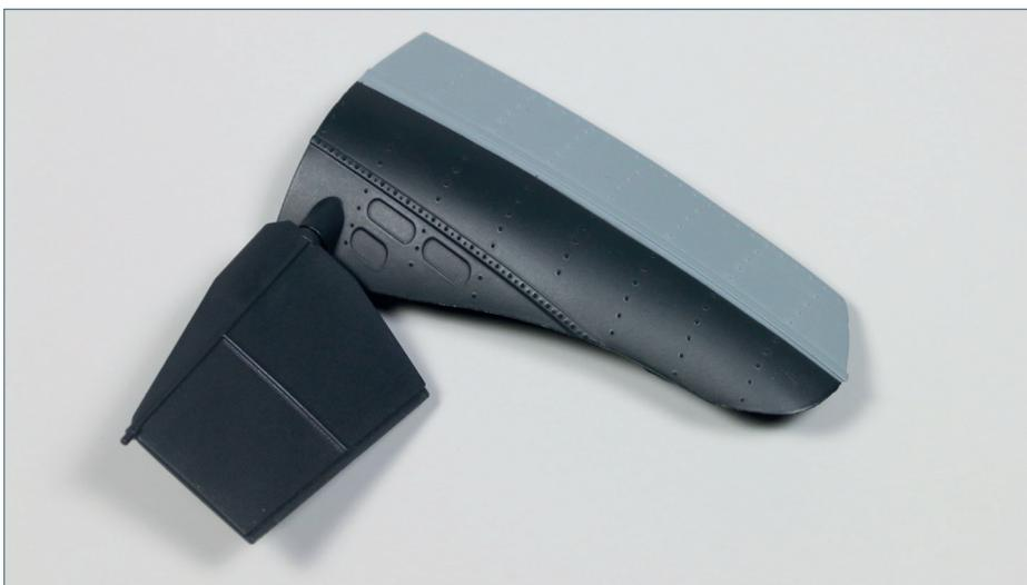
**Am linken Heckteil sind zwei Verbinder und das Backbord-Seitenruder angebracht.**
