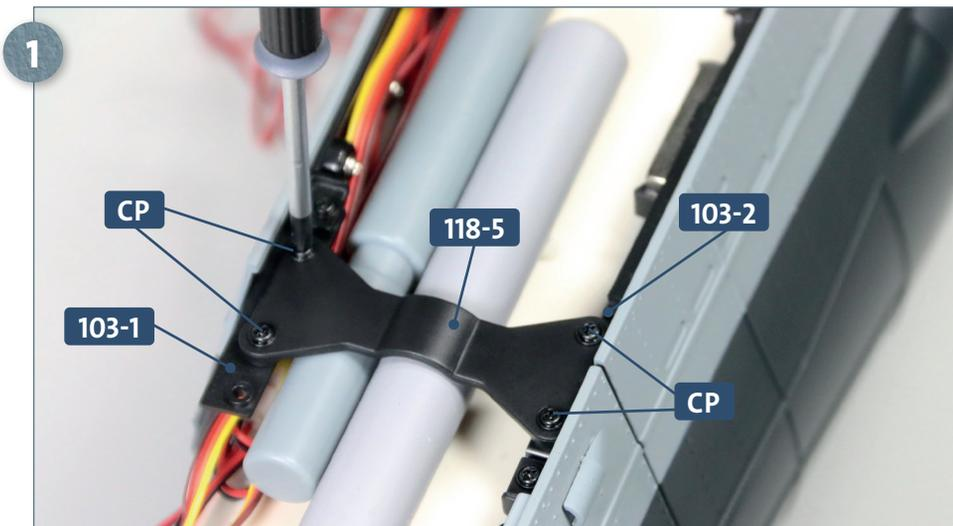
Positionieren Sie den Querträger **118-5** über dem Schalldämpfer und dem Torpedo-Oberdeckbehälter (Detailbild). Fixieren Sie den Querträger mit jeweils zwei Schrauben **CP** an den Verbindungsstücken **103-1** und **103-2**.
