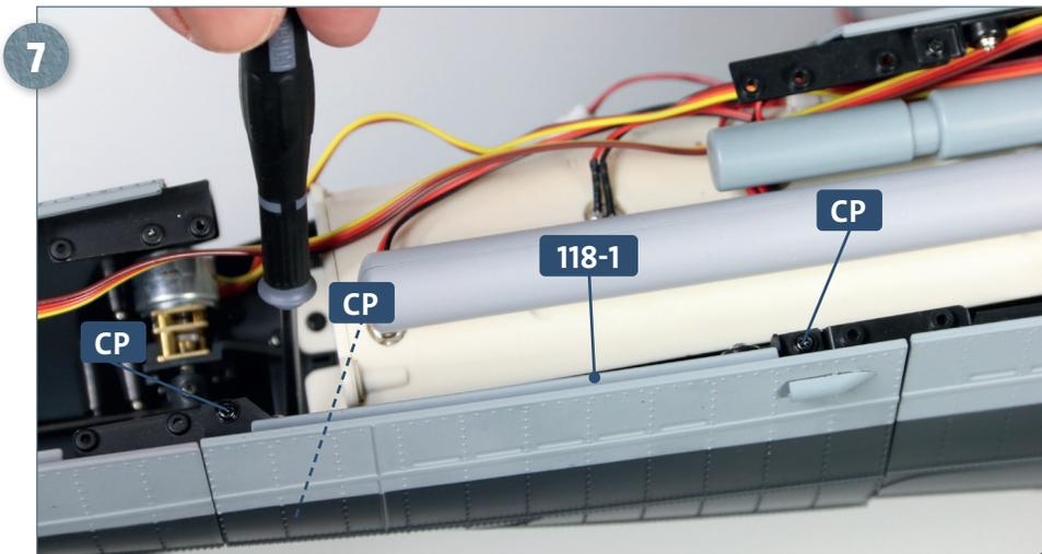
Fixieren Sie den Rumpfabschnitt **118-1** an der Rumpfstruktur, indem Sie seine beiden Verbinder mit insgesamt drei Schrauben **CP** an den Verbindern **99-2** und **99-4** sowie dem Verbindungsstück **103-2** befestigen.
