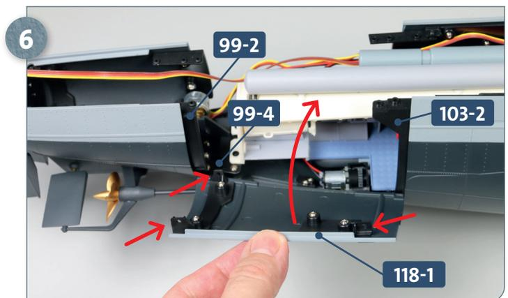
Positionieren Sie den Rumpfabschnitt **118-1** auf der rechten Seite der Rumpfstruktur. Die Bohrungen seiner Verbinder (auf die die drei geraden Pfeile weisen) gehören auf die Aufnahmen der Verbinder **99-2** und **99-4** sowie des Verbindungsstücks **103-2**.
