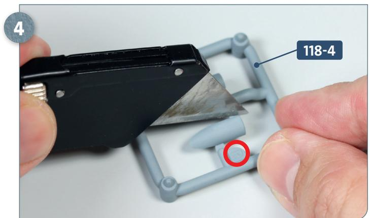
Legen Sie den Rahmen **118-4** mit den beiden Auspuffen bereit. Trennen Sie mit einem Cutter den rechten Auspuff heraus: Dieser ist am Rahmen mit dem Buchstaben „R“ gekennzeichnet (eingekreist).
