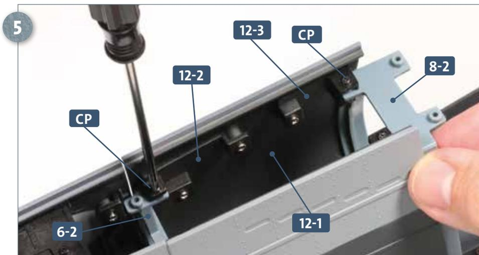
Der Rumpfabschnitt 12-1 ist korrekt auf die Rumpfstruktur gesetzt. Fixieren Sie die beiden Verbinder des Rumpfabschnitts mit je einer Schraube CP an den Verbindungsstücken 6-2 und 8-2, wie abgebildet. (Zwecks besserer Übersichtlichkeit wurde die Rumpfbaugruppe für dieses Bild gedreht.)
