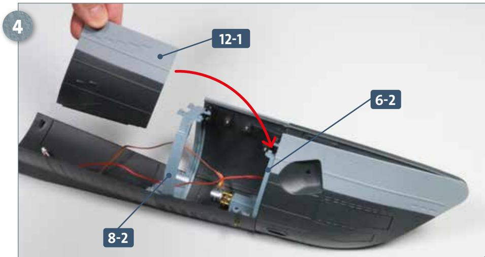
Nehmen Sie die große Rumpfbaugruppe zur Hand, die Sie zuletzt mit Ausgabe 10 bearbeitet haben. Führen Sie den rechten oberen Rumpfabschnitt 12-1 so zur Rumpfbaugruppe, dass er auf den Verbindungsstücken 6-2 und 8-2 aufliegt.
