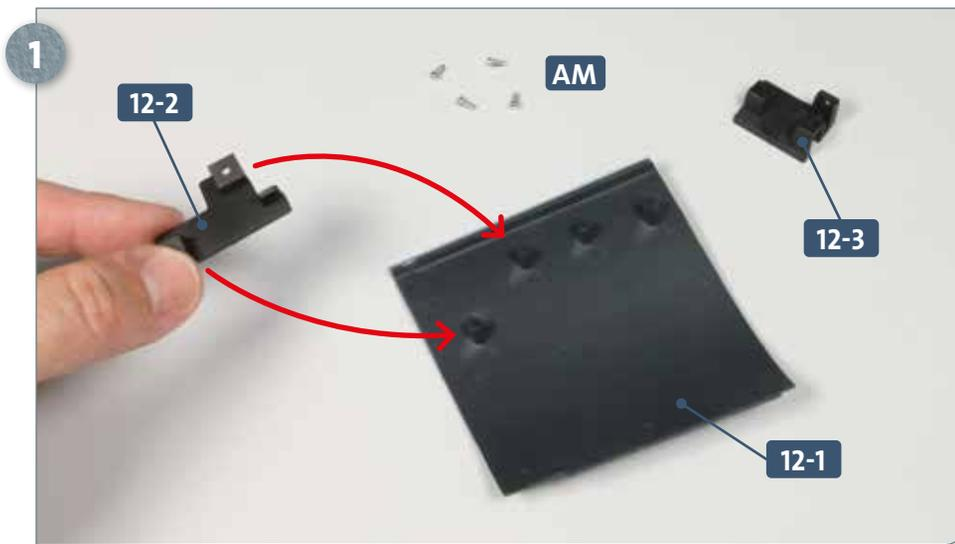
Legen Sie den rechten oberen Rumpfabschnitt 12-1, die beiden Verbinder 12-2 und 12-3 sowie vier Schrauben AM auf Ihre Arbeitsplatte. Nehmen Sie den Verbinder 12-2 und führen Sie ihn zu den beiden linken Aufnahmen am Rumpfabschnitt, wie angedeutet.
