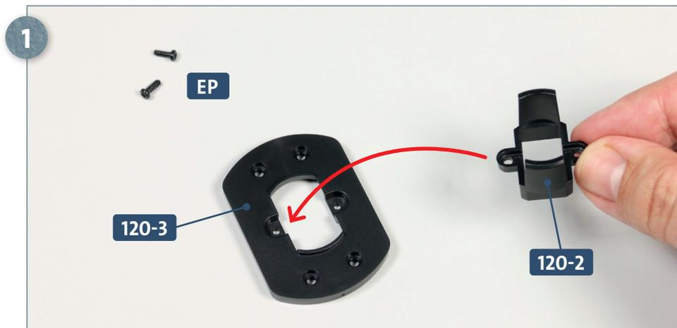
Legen Sie die Unterseite der hinteren Halterung **120-3** und zwei Schrauben **EP** auf Ihrer Arbeitsplatte bereit. Nehmen Sie den Verbinder **120-2** und fügen Sie seine beiden seitlichen Schraubenaufnahmen in die Vertiefungen der Halterung ein, wie es der Pfeil exemplarisch andeutet.
