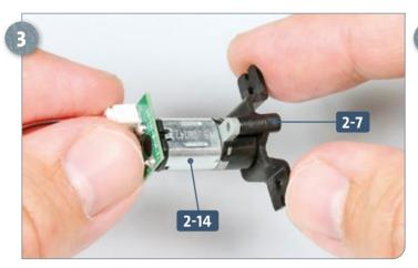
Nehmen Sie die Motorstütze **2-7** und setzen Sie deren zentrale Bohrung auf die Nabe des Motors **2-14**, wie abgebildet.
