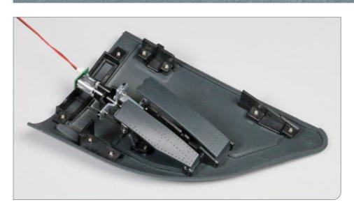
Der Mechanismus zum Öffnen der vier Mündungsklappen wurde zusammengebaut und an der linken Bughälfte befestigt.
