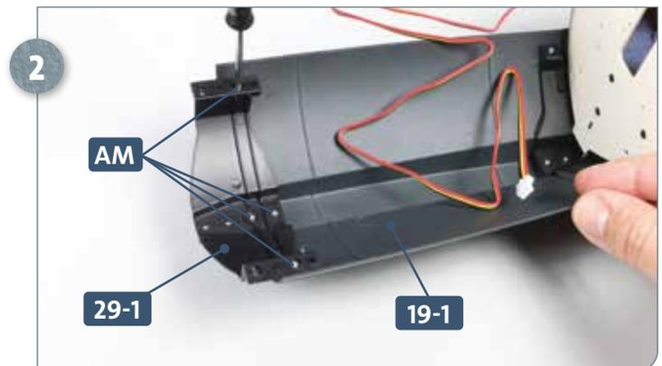
Fixieren Sie das Verbindungsstück **29-1** mit vier Schrauben **AM** am unteren Rumpfabschnitt **19-1**.
