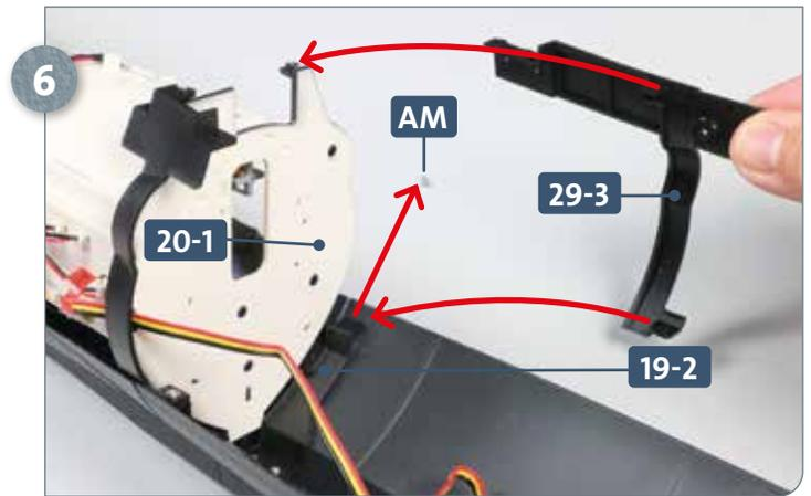
6 Wechsel auf die andere Rumpffseite: Drehen Sie die Schraube AM aus dem Verbindungsstück 19-2 heraus. Führen Sie das Verbindungsstück 29-3 zum Verbindungsstück 19-2 und zum Bugraum-Schott 20-1, wie es die geschwungenen Pfeile andeuten.
