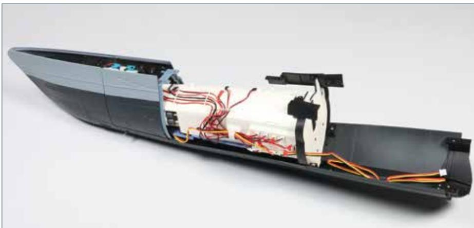
Ein Kabel wurde angeschlossen. Drei Verbindungsstücke wurden an der Rumpffstruktur bzw. dem Bugraum-Schott fixiert.
