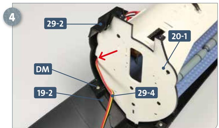
Setzen Sie das Verbindungsstück **29-2** auf das Verbindungsstück **19-2** und fixieren Sie die beiden mit einer Schraube **DM** aneinander. Das Kabel **29-4** muss durch die Aussparung zwischen dem Verbindungsstück **29-2** und dem Bugraum-Schott **20-1** verlaufen.
