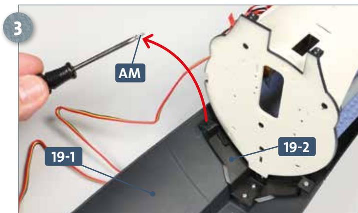
Am vorderen Ende des Rumpfabschnitts **19-1**: Lösen Sie die Schraube **AM** aus dem Verbindungsstück **19-2**.
