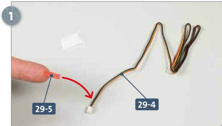
Lösen Sie die Kabelmarkierung **29-5** von der Trägerfolie und bringen Sie sie rund 8 mm entfernt vom Stecker am Kabel **29-4** an.
