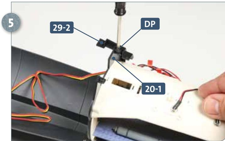
5 An seinem oberen Ende wird das Verbindungsstück 29-2 mit einer Schraube DP an der Lasche des Bugraum-Schotts 20-1 befestigt.
