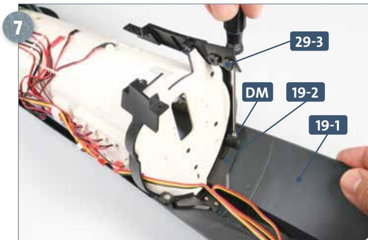
7 Fixieren Sie das Verbindungsstück 29-3 mit einer Schraube DM am Verbindungsstück 19-2 (und damit auch am unteren Rumpfabschnitt 19-1), wie abgebildet.
