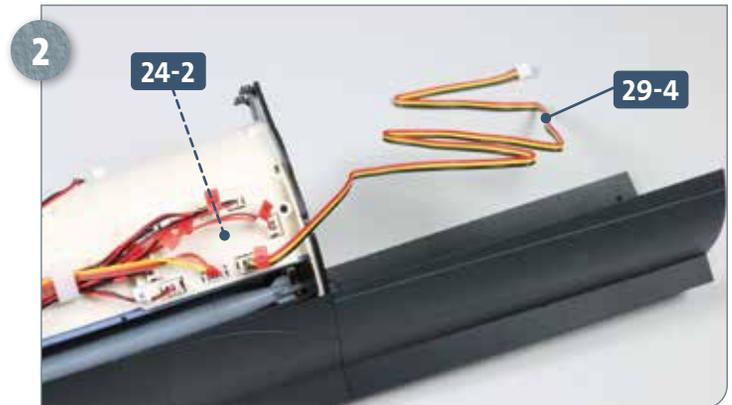
Verbinden Sie einen der Stecker vom Kabel **29-4** mit dem Port 6 der Platine **24-2**. Anders als im Foto dargestellt, verwenden Sie dazu idealerweise den Stecker ohne Kabelmarkierung.
