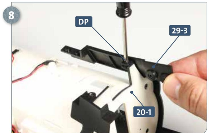
8 An seinem oberen Ende wird das Verbindungsstück 29-3 mit einer Schraube DP an der Lasche des Bugraum-Schotts 20-1 befestigt.
