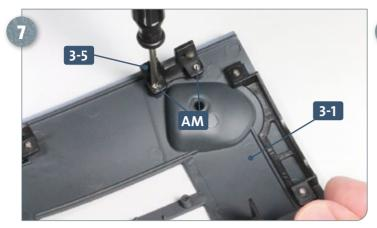
Befestigen Sie den vierten Verbinder 3-5 mit den zwei Schrauben AM an der rechten Bughälfte 3-1, wie abgebildet.
