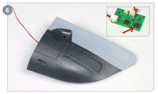
Zum Schließen der Mündungsklappen drücken Sie die rechte Taste der Testplatine, auf die der Pfeil weist. Lassen Sie die Taste los, stoppt der Schließvorgang.
