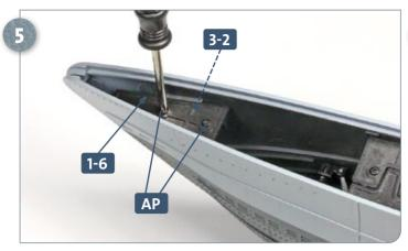
Nahe der Bugspitze werden der erste rechte Verbinder 3-2 und der darüber befindliche erste linke Verbinder 1-6 mit zwei Schrauben AP aneinander befestigt.
