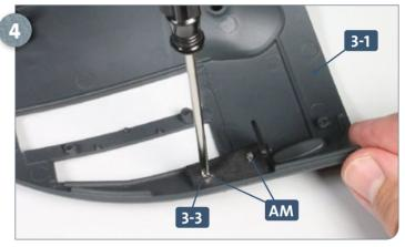
Der Verbinder 3-3 wird ebenfalls mit zwei Schrauben AM an der rechten Bughälfte 3-1 fixiert, wie abgebildet.
