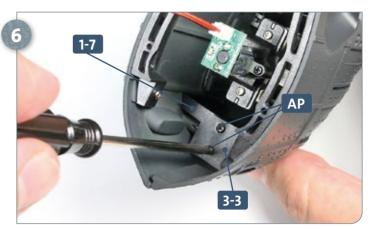
Auch unten werden die beiden Bughälften aneinander fixiert: Drehen Sie dazu zwei Schrauben AP in die Bohrungen der Verbinder 3-3 und 1-7.
