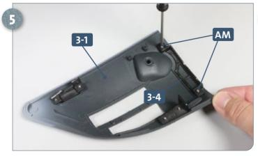
Nehmen Sie den dritten Verbinder 3-4 und befestigen Sie ihn mit zwei Schrauben AM ganz hinten an der rechten Bughälfte 3-1.
