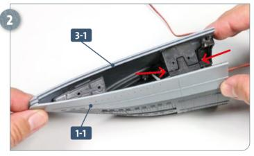
Das Foto zeigt die zusammengefügten Bughälften 1-1 und 3-1. An den hinteren Verbindern (Pfeile) erkennt man, dass die beiden Hälften noch etwas weiter zusammengedrückt werden können.
