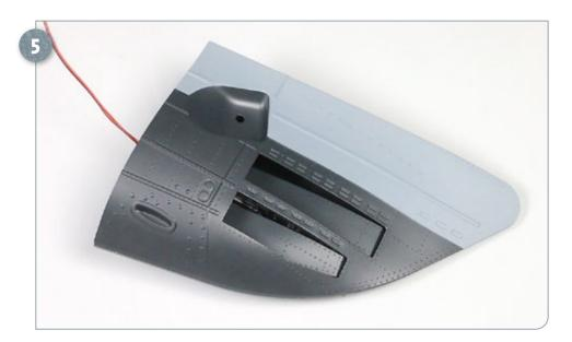
Das Foto zeigt die vollständig geöffneten Mündungsklappen. Lassen Sie die linke Taste der Testplatine los, stoppt der Öffnungsvorgang.
