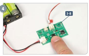
Drücken Sie die linke Taste der Platine **3-8**. Solange Sie die Taste gedrückt halten, öffnen sich die vier Mündungsklappen.
