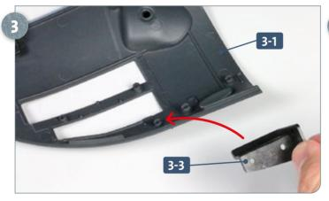
Nehmen Sie den zweiten Verbinder 3-3 und führen Sie ihn zu den Zapfen, die sich ganz unten an der rechten Bughälfte 3-1 befinden, wie es der Pfeil andeutet.
