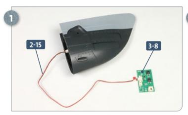
Nehmen Sie das Kabel **2-15** und fügen Sie seinen freien Stecker in den abgebildeten Port der Testplatine **3-8** ein.
