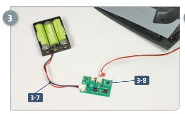
Verbinden Sie den Stecker am Kabelende der Batteriebox 3-7 mit dem Port der Testplatine 3-8, wie abgebildet.
