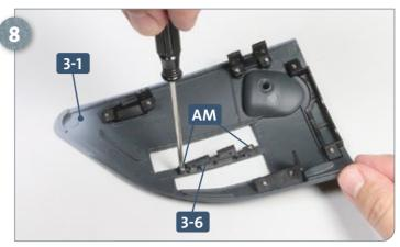
Als Letztes wird der fünfte Verbinder **3-6** zwischen die Öffnungen für die Mündungsklappen geführt und dort mit zwei Schrauben **AM** an der rechten Bughälfte **3-1** befestigt.
