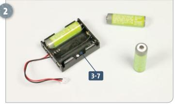
Legen Sie die Batteriebox **3-7** bereit. Nehmen Sie drei Batterien AA (Mignon) und fügen Sie sie in die Batteriebox ein, wie angedeutet.
