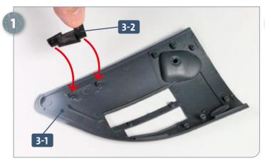
Legen Sie die rechte Bughälfte 3-1 mit der Außenseite nach unten auf Ihre Arbeitsplatte. Nehmen Sie den ersten Verbinder 3-2 und führen Sie seine Bohrungen zu den beiden vorderen Zapfen am Bugteil, wie angedeutet.
