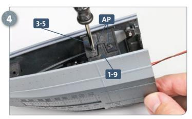
Fixieren Sie den vierten Verbinder der rechten Bughälfte 3-5 mit zwei Schrauben AP am vierten Verbinder der linken Bughälfte 1-9, wie es das Foto zeigt.
