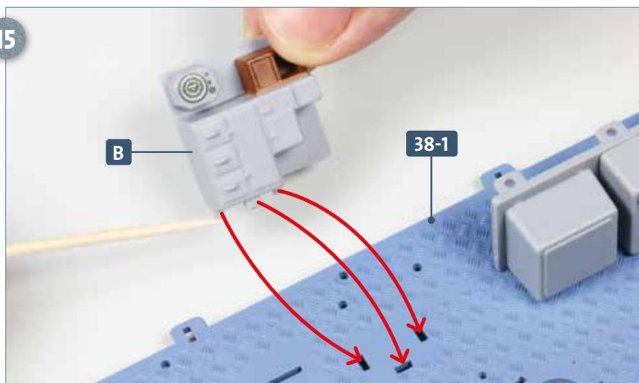
Versehen Sie die drei Zapfen an der Unterseite der Spinde **B** mit etwas Sekundenkleber und fügen Sie diese in die drei Schlitze der Bodenplatte **38-1** ein, auf die die Pfeile weisen.
