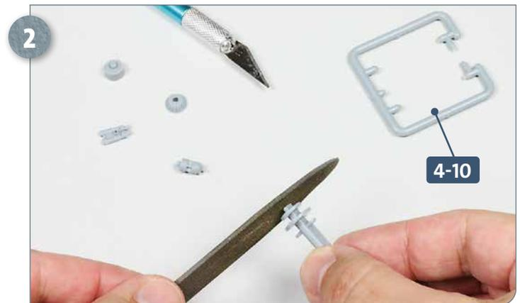
2 Trennen Sie die fünf Teile vorsichtig aus dem Rahmen 4-10 und entfernen Sie mit einer kleinen Flachfeile vorsichtig Überreste der Verbindungsstege zum Rahmen.
