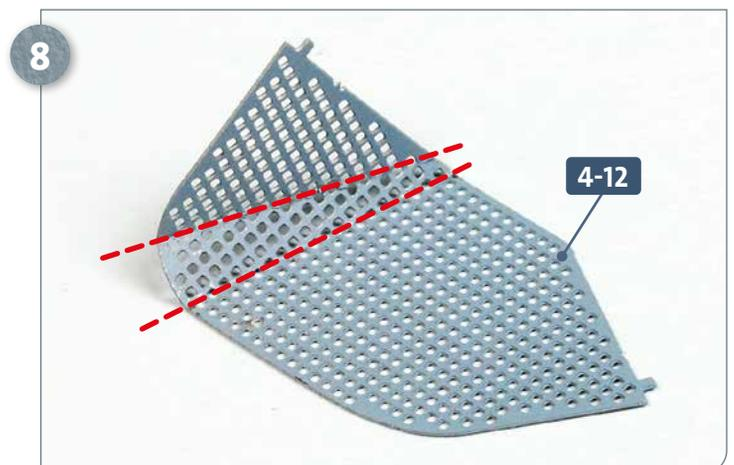
8 Nehmen Sie den Hülsenauffangkorb **4-12** und biegen Sie sein eines Ende mithilfe einer Flachzange entlang der Falze (rote Linien) um jeweils etwa 45° nach oben. Beachten Sie, dass sich die Falze an der Außenseite der Biegung befinden – im Bild also nicht sichtbar sind.
