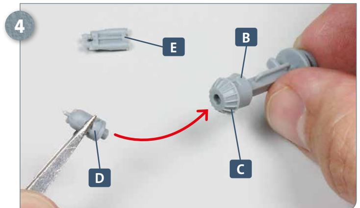
4 Der obere Gradkranz C ist am unteren Gradkranz B festgeklebt. Kleben Sie anschließend die Halterung D in der Vertiefung des Gradkranzes C fest, wie angedeutet. Legen Sie das Doppelfernglas E bereit.
