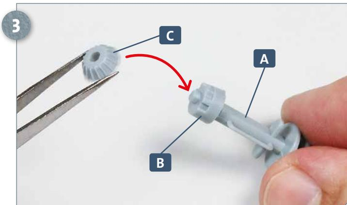
3 Kleben Sie den unteren Gradkranz B oben an der Säule A fest. Nehmen Sie anschließend den oberen Gradkranz C und führen Sie ihn zum Zapfen von Gradkranz B, wie angedeutet.
