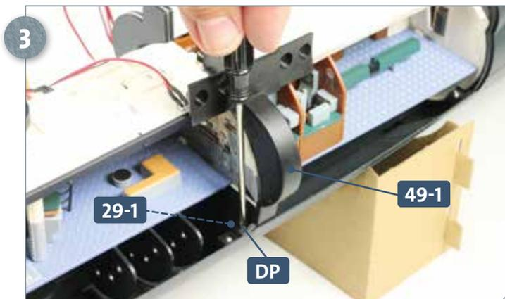
Mit einer weiteren Schraube **DP** wird das Verbindungsstück **49-1** unten am Verbindungsstück **29-1** befestigt.
