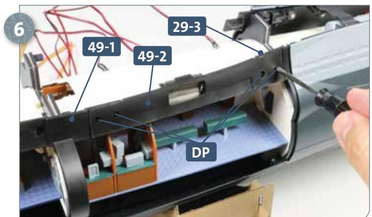
Befestigen Sie die Halteplatte **49-2** mit jeweils zwei Schrauben **DP** an den Verbindungsstücken **29-3** und **49-1**, wie abgebildet.
