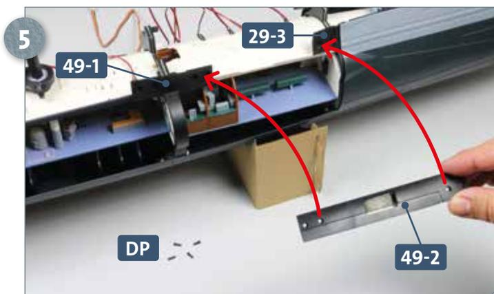
Legen Sie vier Schrauben **DP** bereit. Fügen Sie die Halteplatte **49-2** zwischen den Verbindungsstücken **29-3** und **49-1** ein.
