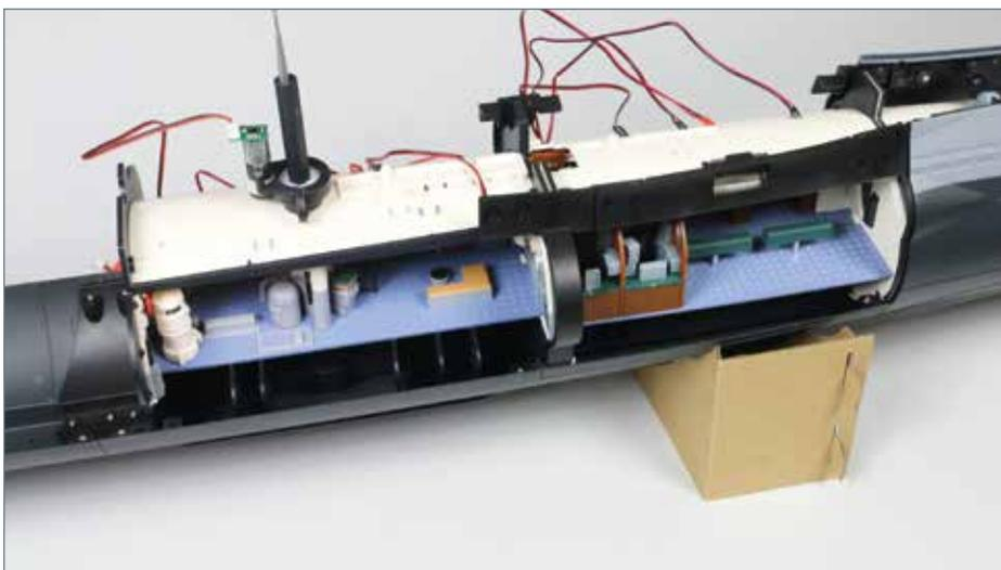
**Zwei Verbindungsstücke und die Halteplatte mit dem zweiten Magneten sind in die Rumpfstruktur eingefügt.**
