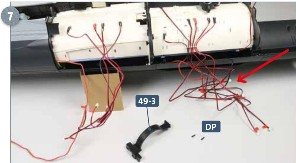
Drehen Sie die Rumpfstruktur um, sodass Sie Zugriff auf deren Backbordseite haben. Legen Sie das Verbindungsstück **49-3** und zwei Schrauben **DP** bereit. Führen Sie die Kabel, auf die der Pfeil weist, zeitweise nach oben in Richtung Angriffsrohr weg (siehe nächster Schritt).
