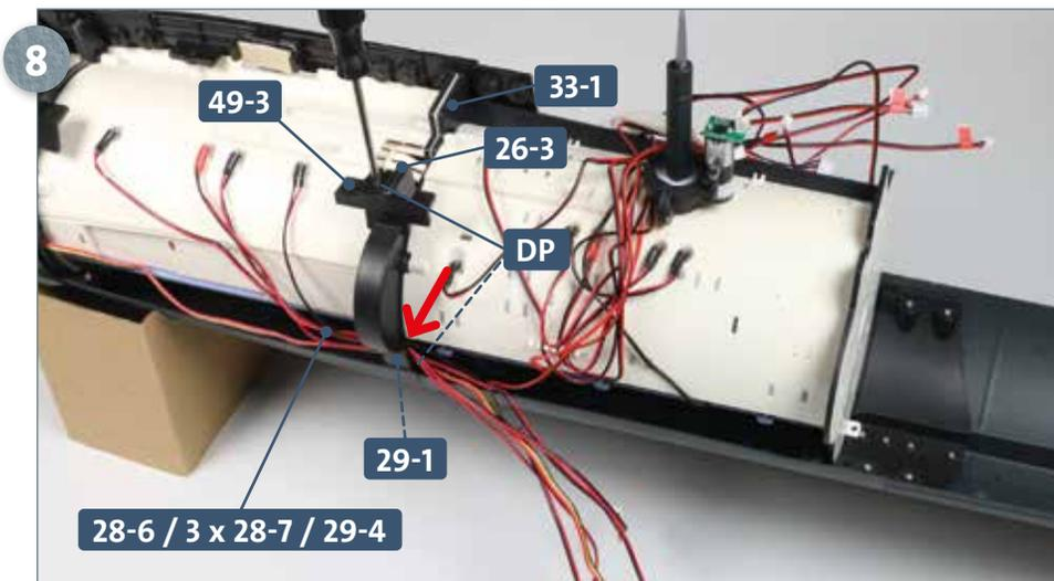
Setzen Sie das Verbindungsstück **49-3** an den beiden benachbarten Schotten **26-3** und **33-1** auf. Führen Sie die fünf Kabel **28-6**, **3 x 28-7** und **29-4** durch die kleine Aussparung unten zwischen Verbindungsstück und Schotten nach achtern (der Pfeil weist auf die Stelle). Fixieren Sie anschließend das Verbindungsstück **49-3** mit je einer Schraube **DP** oben an der Lasche des Schotts **26-3** und unten am Verbindungsstück **29-1**, wie es das Foto zeigt.
