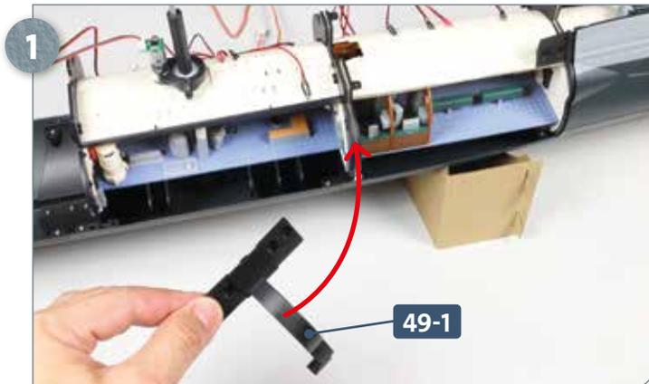
Positionieren Sie die Rumpfstruktur so auf Ihrer Arbeitsplatte, dass Sie Zugriff auf die (offene) Steuerbordseite haben. Führen Sie das Verbindungsstück **49-1** zu den beiden Schotten in der Mitte der Sektionen 2 und 3, wie es der Pfeil andeutet.
