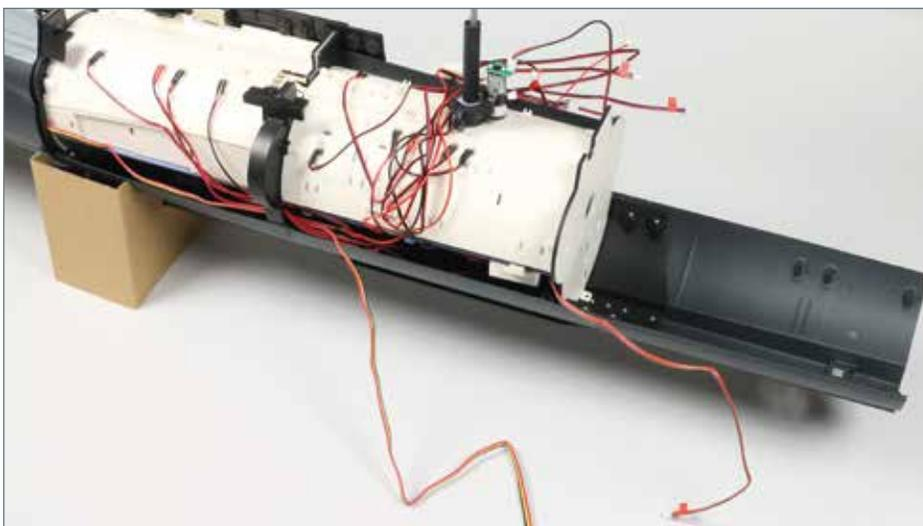
**Fünf Kabel wurden mit der gelieferten Platine verbunden. Die Platinen-Baugruppe ist an der Rückseite der Zentrale-Baugruppe angebracht.**
