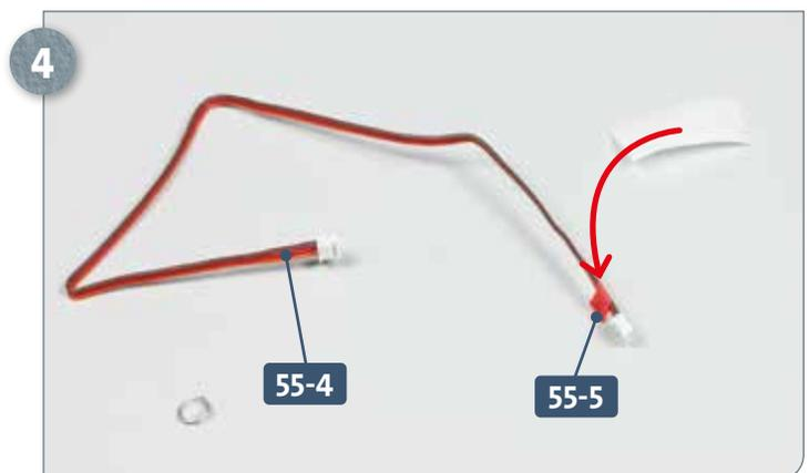
Legen Sie das Kabel **55-4** bereit. Lösen Sie die Kabelmarkierung **55-5** von der Trägerfolie und bringen Sie sie unweit des einen Steckers vom Kabel an, wie abgebildet.
