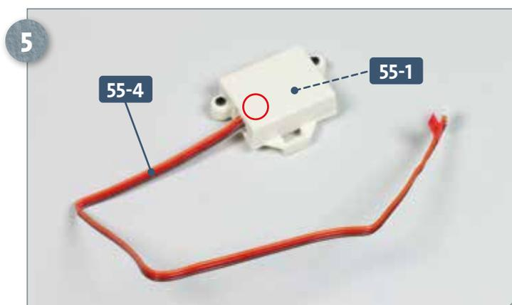
Fügen Sie den Stecker vom Kabel **55-4**, an dessen Ende sich keine Kabelmarkierung befindet, in den Port 5 (eingekreist) der Platine **55-1** ein, wie es das Foto zeigt.
