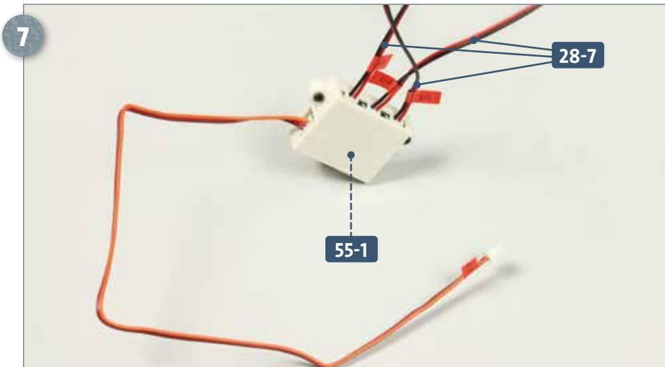
Fügen Sie die Stecker der drei mit L-1 markierten Kabel 28-7 in die Ports 1, 2 und 3 der Platine 55-1 ein, wie abgebildet. Anschließend wird das mit L-2 markierte Kabel 28-6 mit dem Port 4 der Platine 55-1 verbunden (Detailbild).
