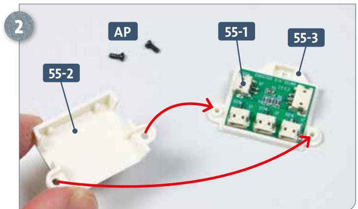
Die Platine **55-1** befindet sich auf dem Rückteil der Platinenverkleidung **55-3**. Setzen Sie das Vorderteil der Platinenverkleidung **55-2** auf das Rückteil, wie angedeutet. Legen Sie zwei Schrauben **AP** bereit.
