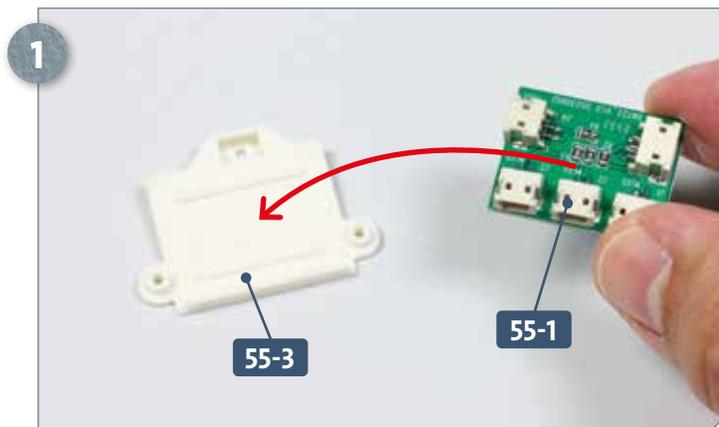
Legen Sie das Rückteil der Platinenverkleidung **55-3** auf Ihre Arbeitsplatte. Nehmen Sie die Platine **55-1** und platzieren Sie sie auf dem Verkleidungsteil, wie es der Pfeil andeutet.
