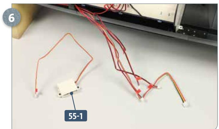
Legen Sie die Baugruppe mit der Platine **55-1** auf Höhe der Zentrale vor die Backbordseite der Rumpfstruktur, wie abgebildet.
