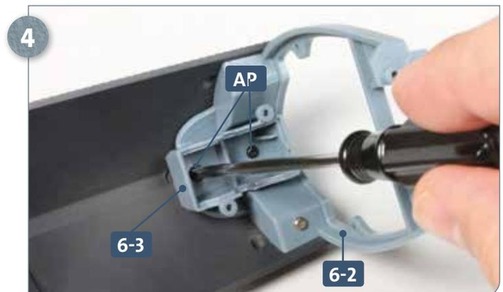
Befestigen Sie das Getriebegehäuse **6-3** am Verbindungsstück **6-2**, indem Sie zwei Schrauben **AP** eindrehen.
