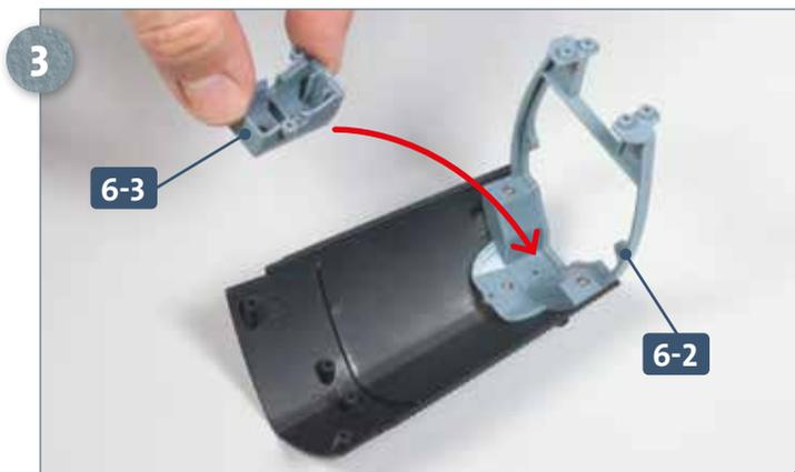
Nehmen Sie das Getriebegehäuse **6-3** und führen Sie es zum Verbindungsstück **6-2**. Achten Sie dabei unbedingt auf die Ausrichtung des Getriebegehäuses.
