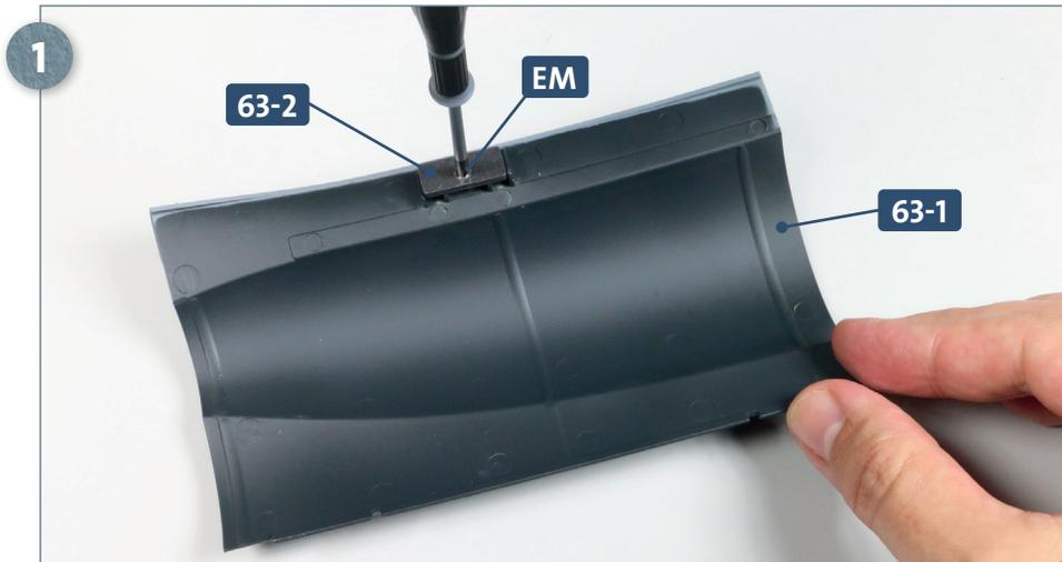
Legen Sie den Rumpfabschnitt **63-1** mit der Innenseite nach oben auf Ihre Arbeitsplatte. Nehmen Sie die Metallplatte **63-2**, setzen Sie sie bündig auf die Bohrung im Rumpfabschnitt und befestigen Sie sie mit einer Schraube **EM**, wie angedeutet.
