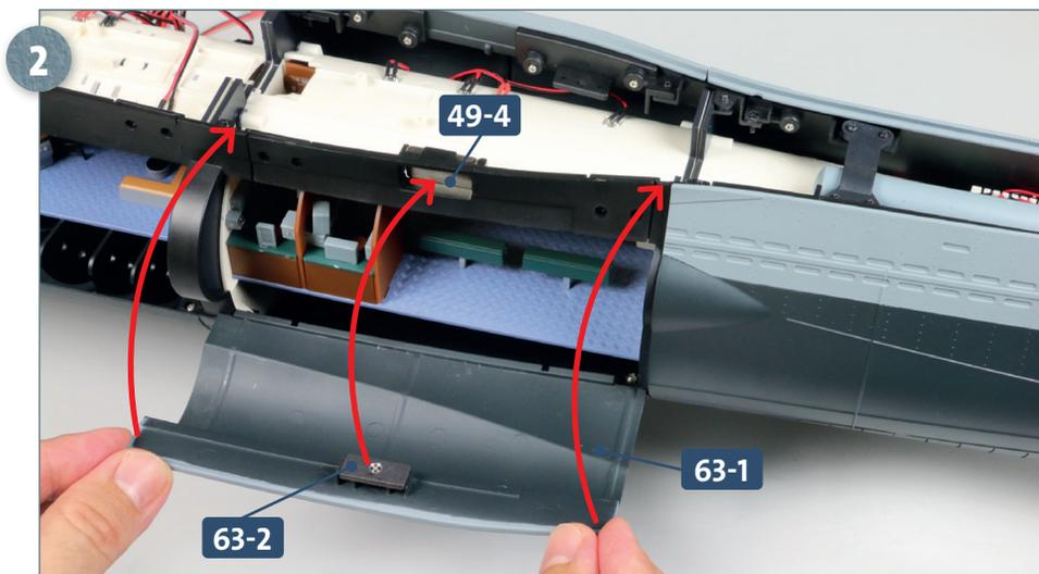
Stellen Sie die Rumpfstruktur so auf Ihre Arbeitsplatte, dass Sie Zugriff auf deren rechte Seite haben. Platzieren Sie die Lippe unten am Rumpfabschnitt **63-1** auf der Kante des Kielteils unter der zweiten Sektion. Kippen Sie **63-1** so nach oben, dass die Metallplatte **63-2** am Magneten **49-4** sitzt, wie es der mittlere Pfeil andeutet.
