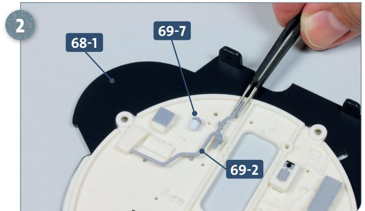
Kleben Sie das Anbauteil **69-7** und die Motorölleitung **69-2** am Dieselausschott **68-1** fest, wie abgebildet. Geben Sie dazu etwas Sekundenkleber auf die Zapfen der Teile.
