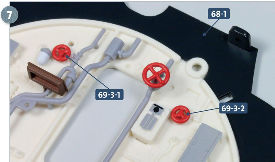
Trennen Sie die beiden Handräder **69-3-1** und **69-3-2** aus dem Rahmen **69-3** und kleben Sie sie in den kleinen Bohrungen des Dieselraumschotts **68-1** fest, wie es das Foto zeigt.
