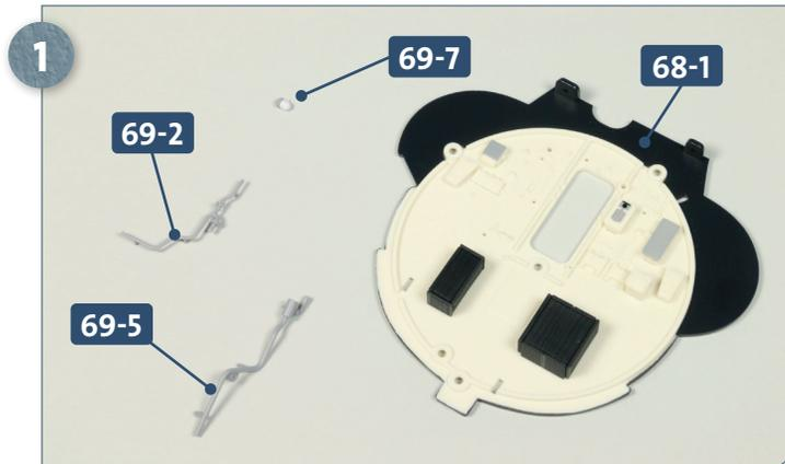
Legen Sie das vordere Dieselausschott **68-1**, die beiden Motorölleitungen **69-2** und **69-5** sowie das Anbauteil **69-7** auf Ihre Arbeitsplatte, wie abgebildet.
