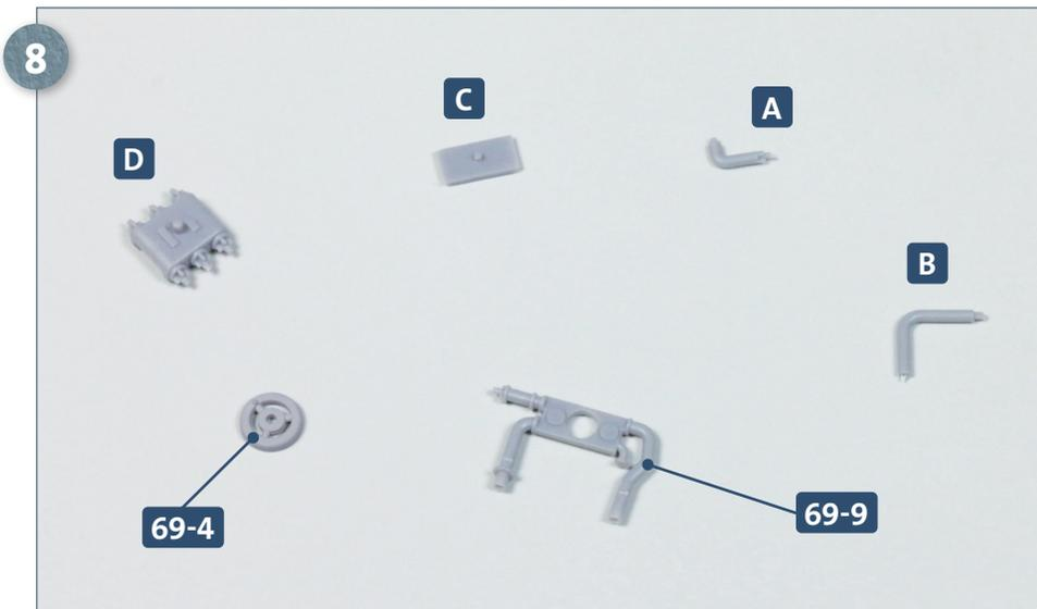
Nun wird die Motorölverteiler-Baugruppe zusammengesetzt. Legen Sie dazu den Motorölverteiler **69-9** und das Handrad **69-4** bereit. Trennen Sie die zwei Teile **A** und **B** aus dem Rahmen **69-8** und die Teile **C** und **D** aus dem Rahmen **69-10**.
