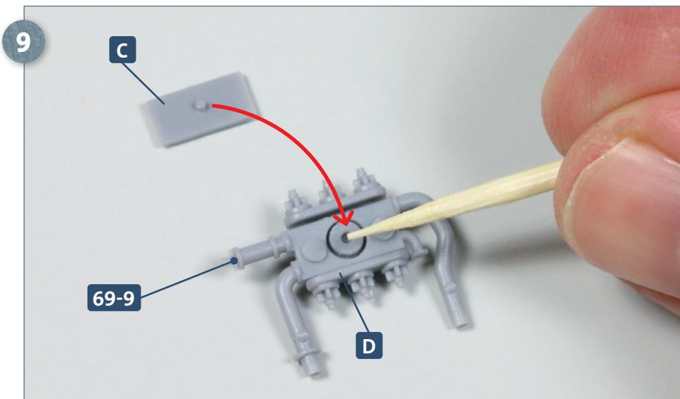
Fügen Sie den Motorölverteiler **69-9** so in das Teil **D** ein, dass seine Bohrung die zentrale vorspringende Aufnahme von **D** umfasst. Geben Sie etwas Sekundenkleber auf diese Aufnahme und kleben Sie das Teil **C** an ihr fest, wie es der Pfeil andeutet.
