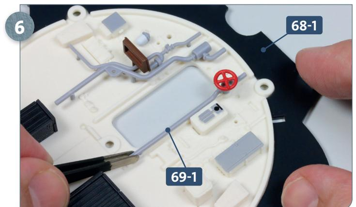
Geben Sie etwas Sekundenkleber auf die beiden Zapfen der Treibölleitung **69-1** und fügen Sie diese in die Bohrungen des Dieselausschotts **68-1** ein.
