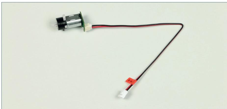
**Der Motor für die Drehung des Luftzielsehrohrs ist mit einem Kabel verbunden.**
