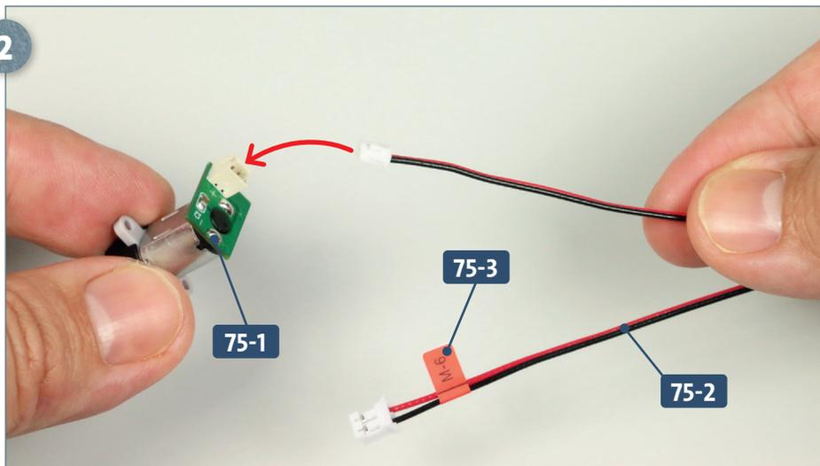
Die Kabelmarkierung **75-3** ist am Kabel **75-2** befestigt. Fügen Sie den kleineren Stecker des Kabels in den Port der Platine ein, die am Motor **75-1** angebracht ist, wie es der Pfeil andeutet.
