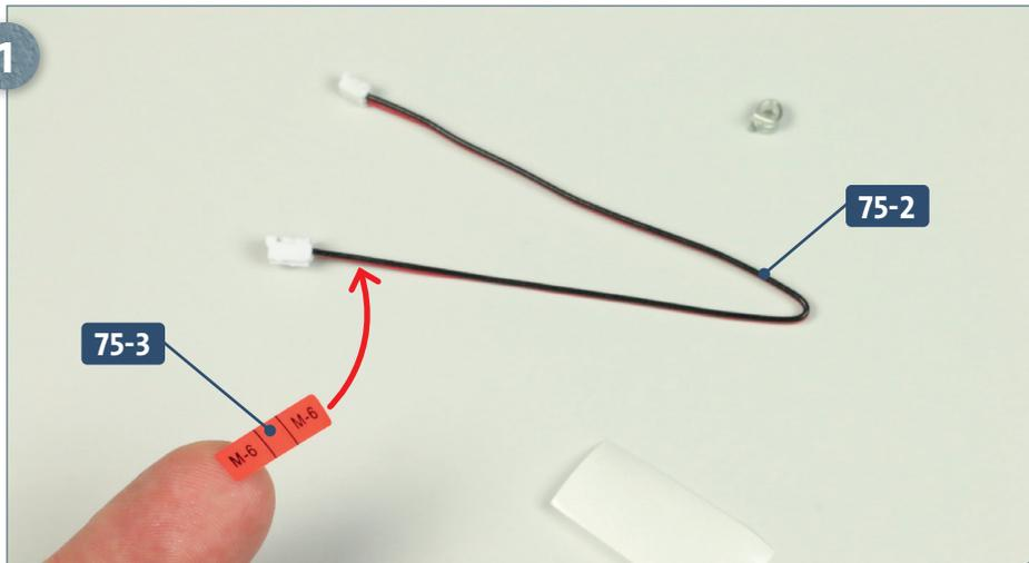
Legen Sie die Kabelmarkierung **75-3** und das Kabel **75-2** bereit. Entfernen Sie die Umwicklung vom Kabel, wie abgebildet. Lösen Sie die Kabelmarkierung von der Trägerfolie und bringen Sie sie mit einem Abstand von rund 8 mm zum breiteren Stecker am Kabel an, wie angedeutet.
