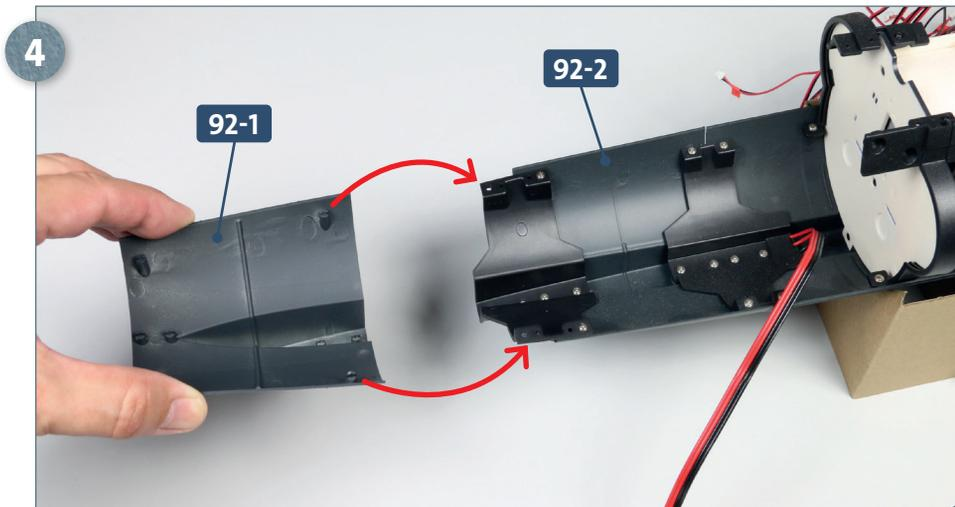
Nehmen Sie den unteren Rumpfabschnitt **92-1**, richten Sie ihn aus, wie abgebildet, und führen Sie seine vorderen Aufnahmen zu den hinteren Bohrungen des Verbindungsstücks **92-2**, wie angedeutet.
