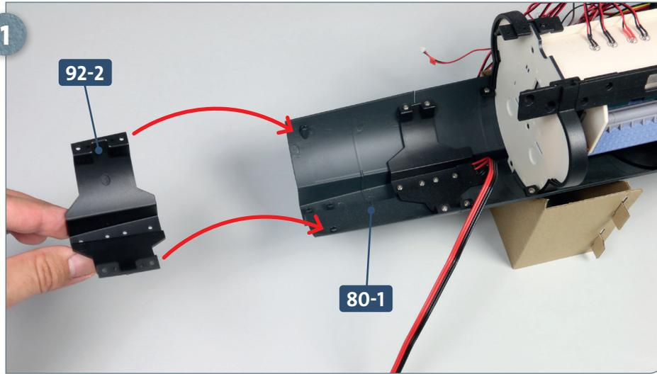
Legen Sie die Rumpfstruktur auf Ihre Arbeitsplatte. Nehmen Sie das Verbindungsstück **92-2**, richten Sie es aus, wie abgebildet, und führen Sie es zu den Aufnahmen hinten am unteren Rumpfabschnitt **80-1**, wie es die Pfeile andeuten.
