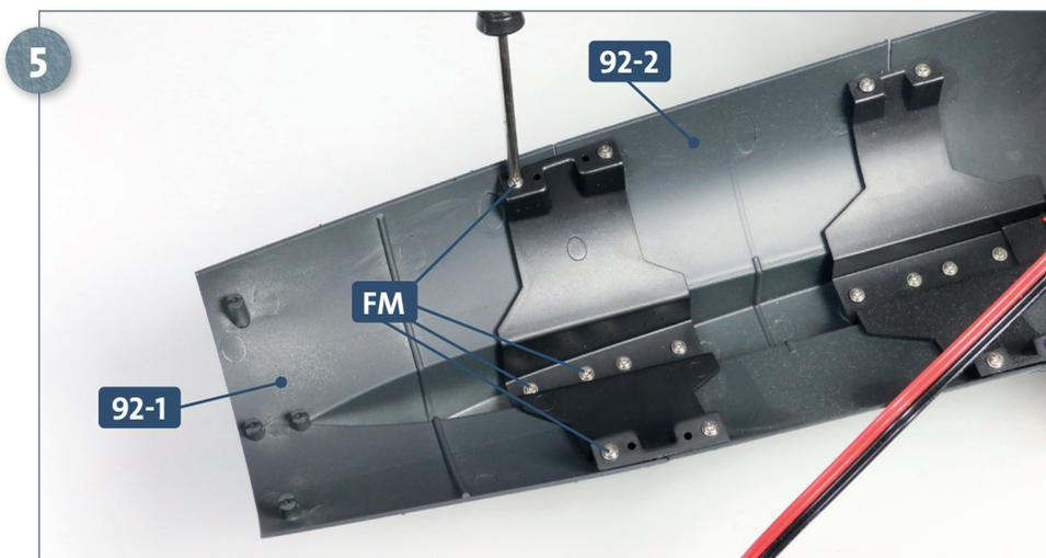
Befestigen Sie den unteren Rumpfabschnitt **92-1** mit vier Schrauben **FM** am Verbindungsstück **92-2**.
