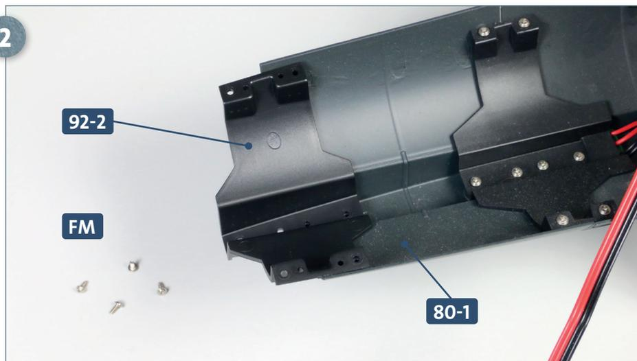
Das Verbindungsstück **92-2** ist korrekt auf dem Rumpfabschnitt **80-1** platziert. Legen Sie vier Schrauben **FM** bereit.
