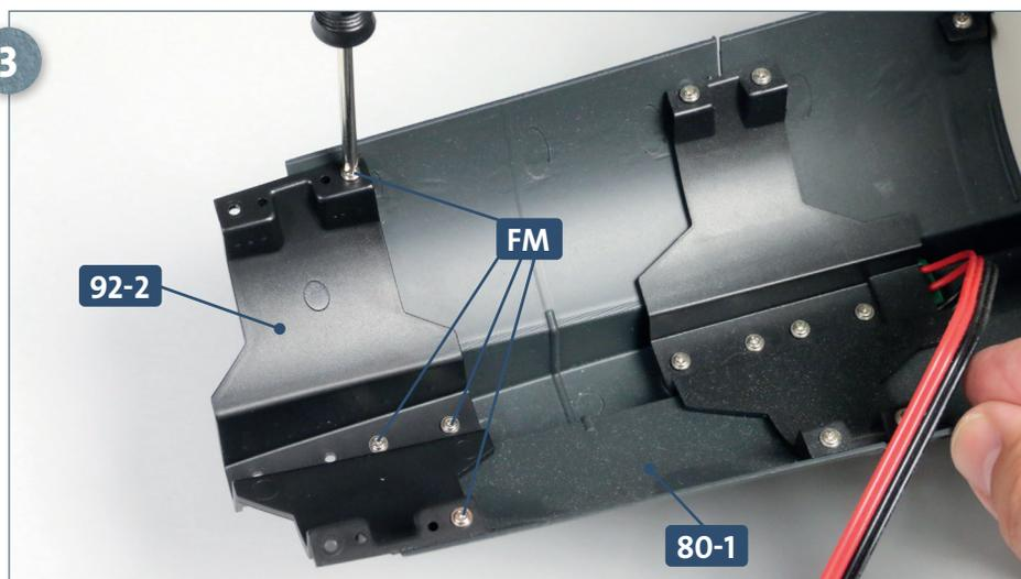
Fixieren Sie das Verbindungsstück **92-2** am unteren Rumpfabschnitt **80-1**, indem Sie die vier Schrauben **FM** eindrehen.
