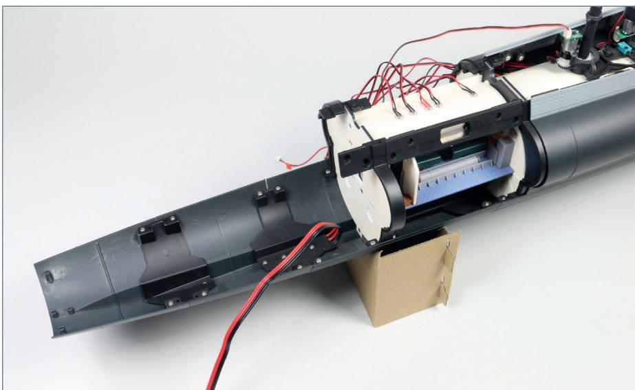
Am hinteren Ende der Rumpfstruktur wurden ein Verbindungsstück und ein Rumpfabschnitt befestigt.
