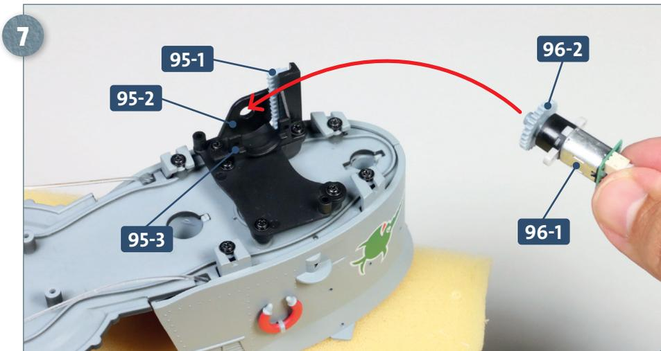
Die Ansicht des eingesetzten Funkpeilrahmens **95-1** von unten. Sollte es beim Durchschieben haken, lösen Sie die beiden Schrauben, mit denen die Führung **95-3** fixiert ist, und nehmen Sie die Führung zeitweise ab. Ist der Funkpeilrahmen korrekt eingesetzt, befestigen Sie die Führung wieder. Nehmen Sie anschließend die Motor-Baugruppe und fügen Sie das aufgesetzte Zahnrad **96-2** in die große Öffnung der Halterung **95-2** ein, wie es der Pfeil andeutet.
