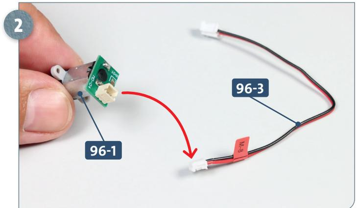
Nehmen Sie den Motor **96-1** und verbinden Sie den Port von dessen Platine mit dem kleineren Stecker des Kabels **96-3**, wie es der Pfeil andeutet.
