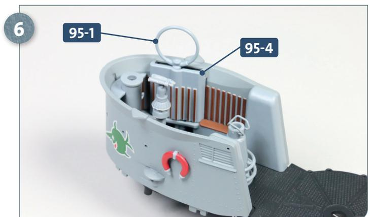
Der Funkpeilrahmen **95-1** sitzt in der Öffnung zwischen dem Verkleidungsteil **95-4** und dem Schanzkleid. Sein unteres Ende wird durch die Öffnung des Brückendecks **4-2** geführt.
