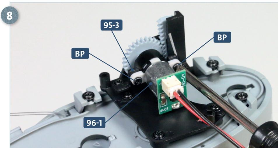
Befestigen Sie den Motor **96-1** mit zwei Schrauben **BP** an der Führung **95-3**.
