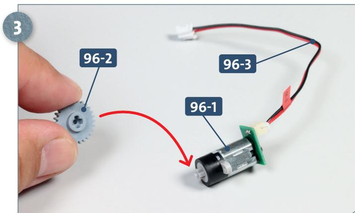
Das Kabel **96-3** ist mit der Platine des Motors **96-1** verbunden. Nehmen Sie das Zahnrad **96-2** und führen Sie es zur Motornabe.
