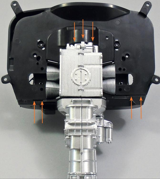
Drehen Sie die Baugruppe um und prüfen Sie, ob die auf dem Foto mit Pfeilen gekennzeichneten Profile passen.
