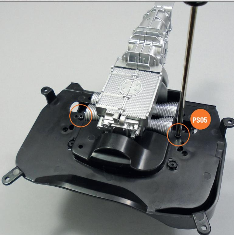
Befestigen Sie die Teile an der Unterseite der Baugruppe, indem Sie zwei Schrauben **PS05** in den auf dem Foto mit Kreisen markierten Löchern festziehen.
