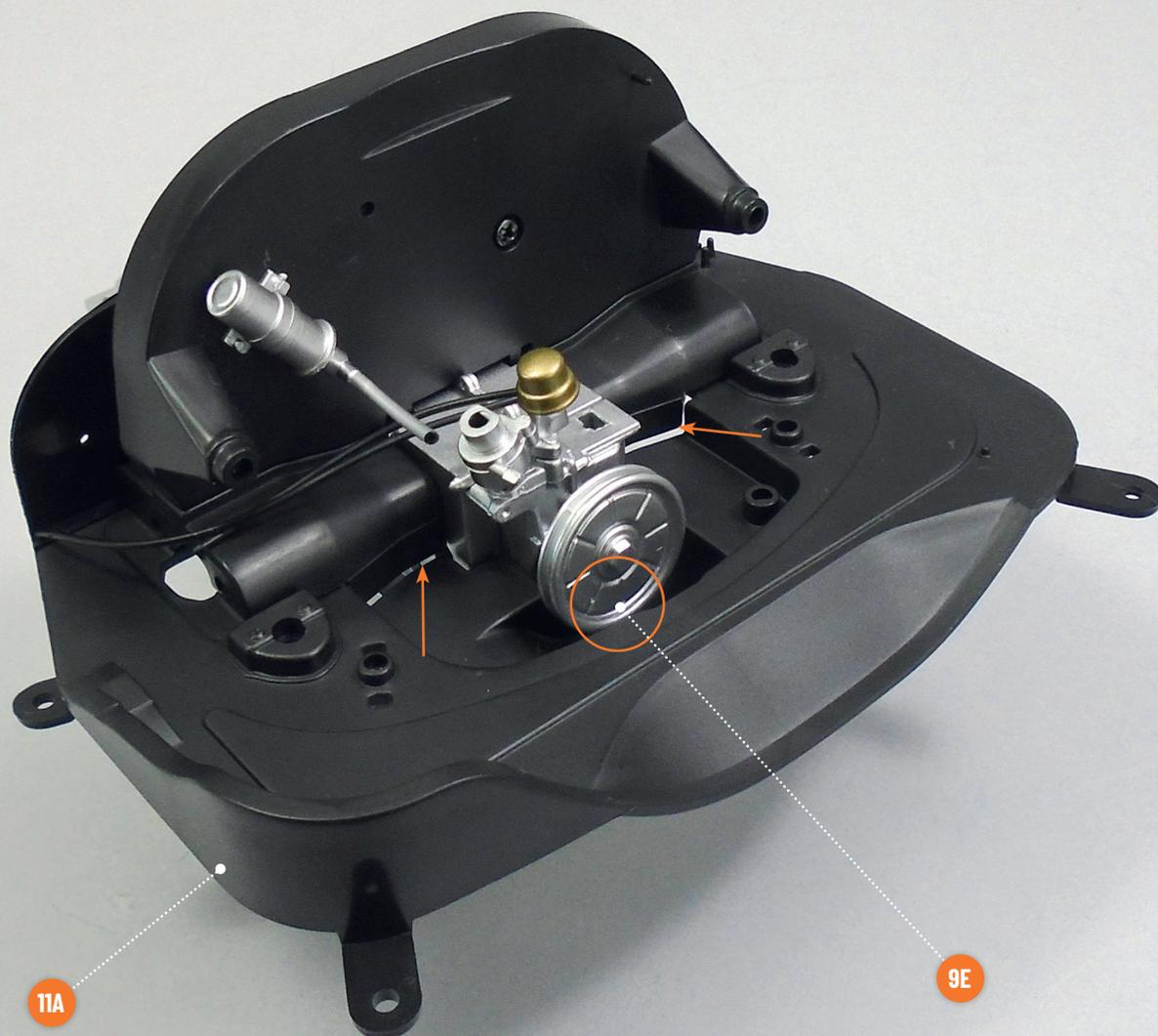
Nehmen Sie die Motor-Getriebe-Baugruppe zur Hand und setzen Sie sie auf die Oberseite des hinteren Motorabdeckblechs **11A**. Richten Sie dabei die Teile wie auf dem Foto gezeigt aus. Um die Riemenscheibe **9E** korrekt in ihre Aussparung einzusetzen, kippen Sie das Motorabdeckblech und schieben Sie die Teile zusammen, bis die auf dem Foto mit Pfeilen angezeigten Bereiche übereinstimmen.
