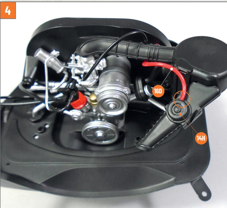
Stecken Sie das andere Ende des roten Schlauchs **16D** auf den seitlichen Stift des Luftfilters **14H**.
