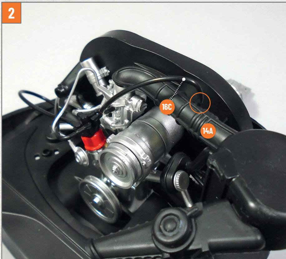
Stecken Sie das andere Ende des schwarzen Unterdruckschlauchs **16C** auf den Stift oben am Filter **14A**, der im Foto durch den Kreis gekennzeichnet ist.
