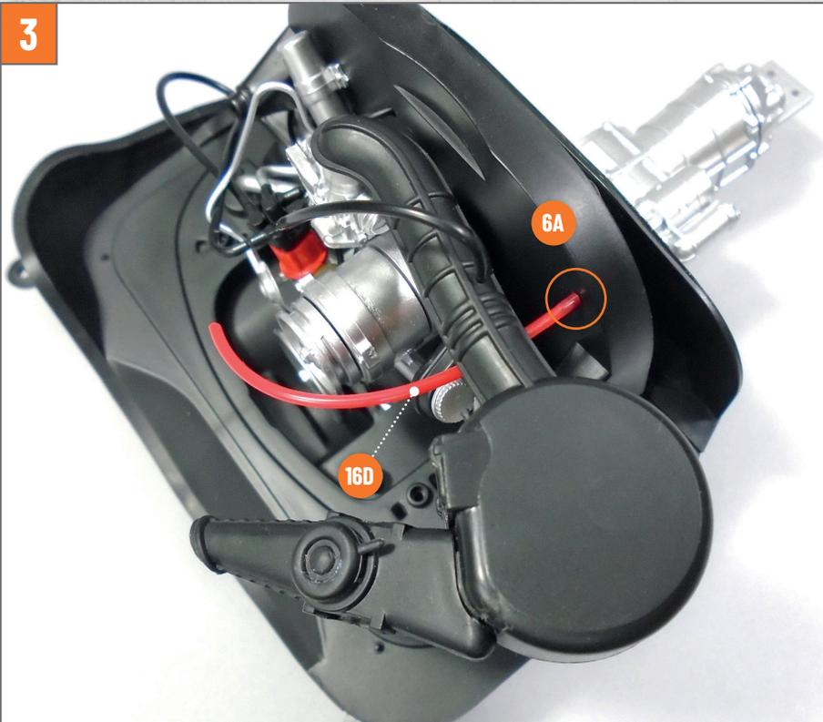
Stecken Sie ein Ende des roten Schlauchs für die Gebläseentlüftung **16D** auf den im Foto gezeigten Stift des Gebläsekastens **6A**.
