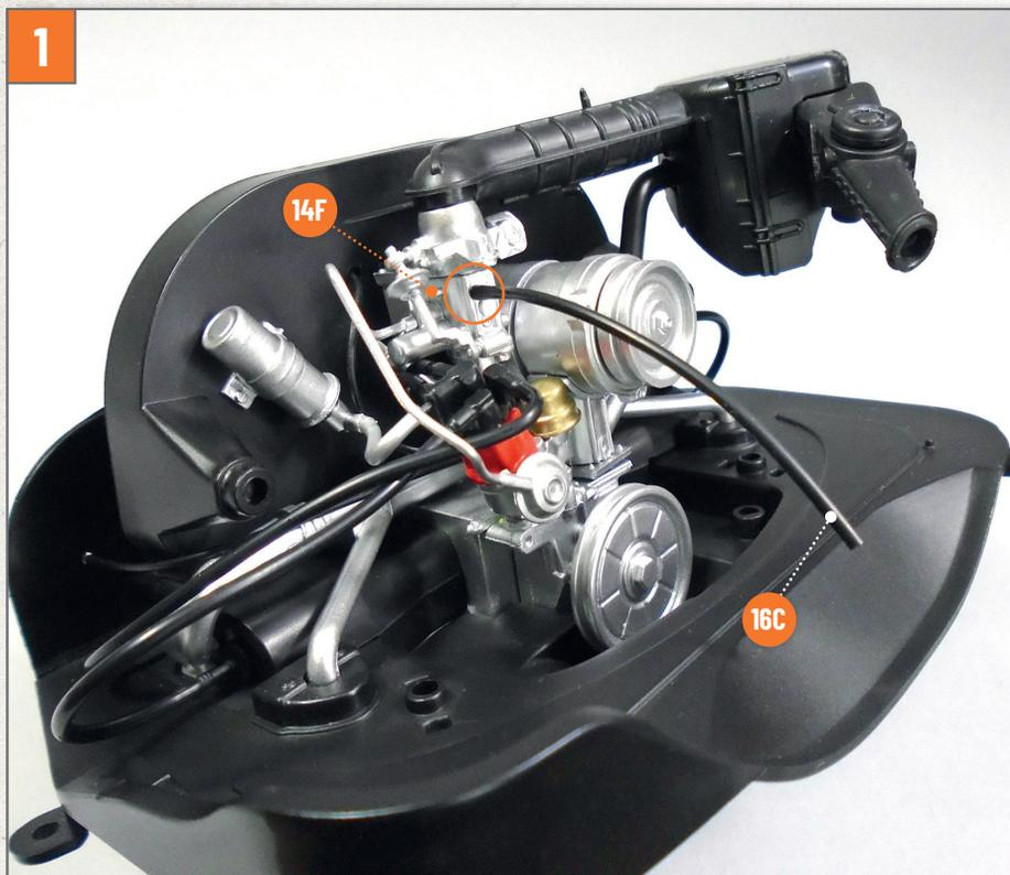
Nehmen Sie den Motor Ihres Modells zur Hand. Stecken Sie ein Ende des schwarzen Unterdruckschlauchs **16C** auf den Stift am Unterteil des Vergasers **14F**, der im Foto durch den Kreis gekennzeichnet ist.
