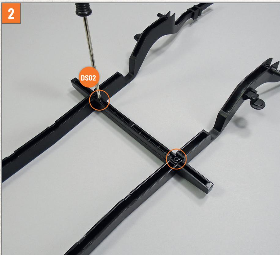
Ziehen Sie zwei Schrauben **DS02** in den angezeigten Löchern fest, um die Teile aneinander zu befestigen.
