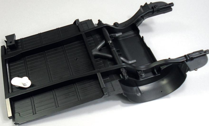
Nehmen Sie jetzt das Bodenblech zur Hand, das Sie in den vorherigen Ausgaben zusammengebaut haben. Installieren Sie den Rahmen auf seiner Unterseite und richten Sie die Komponenten wie auf dem Foto gezeigt aus.
