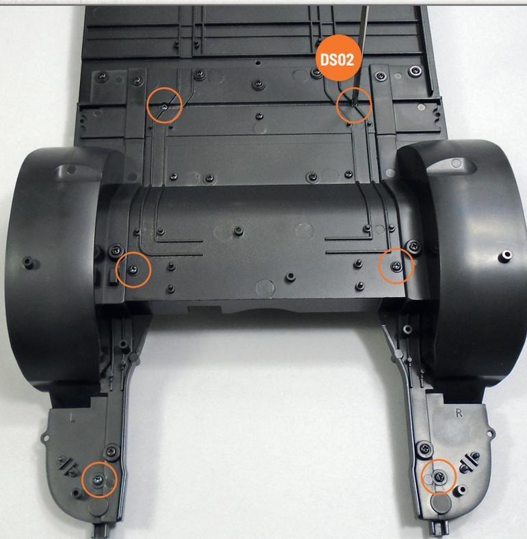
Drehen Sie die Baugruppe um und achten Sie darauf, dass sich dabei keine Teile lösen. Befestigen Sie den Rahmen am Bodenblech, indem Sie sechs Schrauben **DS02** in den auf dem Foto durch Kreise markierten Löchern festziehen.
