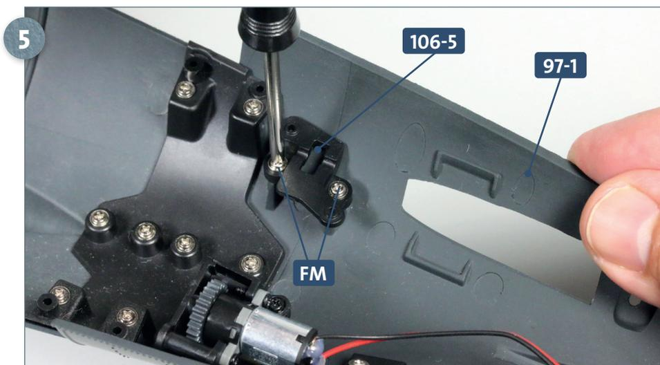
Stellen Sie die Rumpfstruktur so auf Ihre Arbeitsplatte, dass Sie Zugriff auf deren Heckende haben. Positionieren Sie das Motorgehäuse **106-5** auf den beiden Aufnahmen auf der rechten Seite des unteren Rumpfabschnitts **97-1**. Fixieren Sie das Teil mit zwei Schrauben **FM**.
