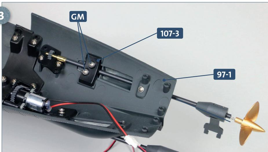
Platzieren Sie die Halteplatte **107-3** über der Welle in der Aussparung des Rumpfabschnitts **97-1** und befestigen Sie sie mit zwei Schrauben **GM**.
