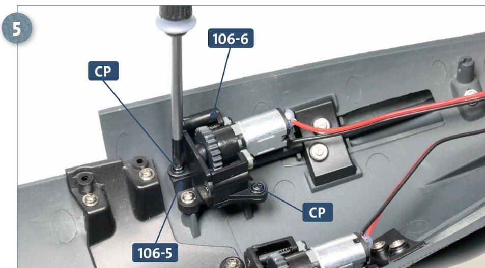
Befestigen Sie die beiden Teile des Motorgehäuses **106-6** und **106-5** aneinander, indem Sie zwei Schrauben **CP** eindrehen.
