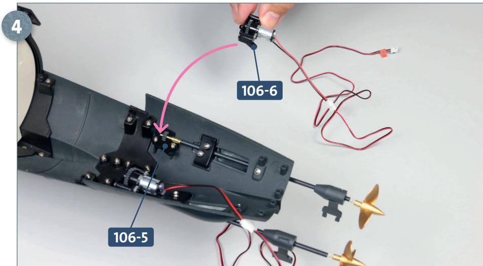
Nehmen Sie die Motorbaugruppe mit dem Gehäuse **106-6**, die Sie mit der letzten Ausgabe zusammengefügt haben, und positionieren Sie sie auf dem bereits am Rumpf befestigten Motorgehäuse **106-5**, wie es der Pfeil andeutet.
