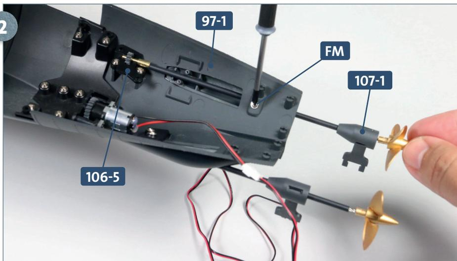
Stellen Sie die Rumpfstruktur so auf Ihre Arbeitsplatte, dass Sie Zugriff auf deren hinteres Ende haben. Führen Sie die Welle der Baugruppe **107-1** von hinten durch die längliche Öffnung im Rumpfabschnitt **97-1**. Das Zahnrad am vorderen Wellenende wird in die Aussparung des Motorgehäuses **106-5** eingefügt. Befestigen Sie die gewölbte Druckguss-Struktur, die sich an der Propellerwellen-Baugruppe **107-1** befindet, mit einer Schraube **FM** an der Rumpfstruktur, wie abgebildet.
