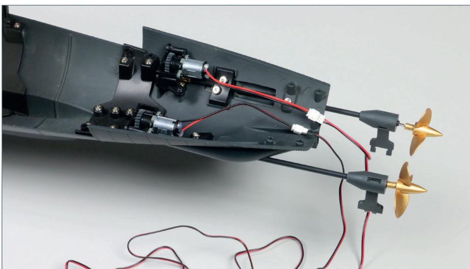
Die Baugruppe mit der rechten Propellerwelle ist an der Rumpfstruktur befestigt. Der Motor für den rechten Propeller ist ebenfalls montiert.
