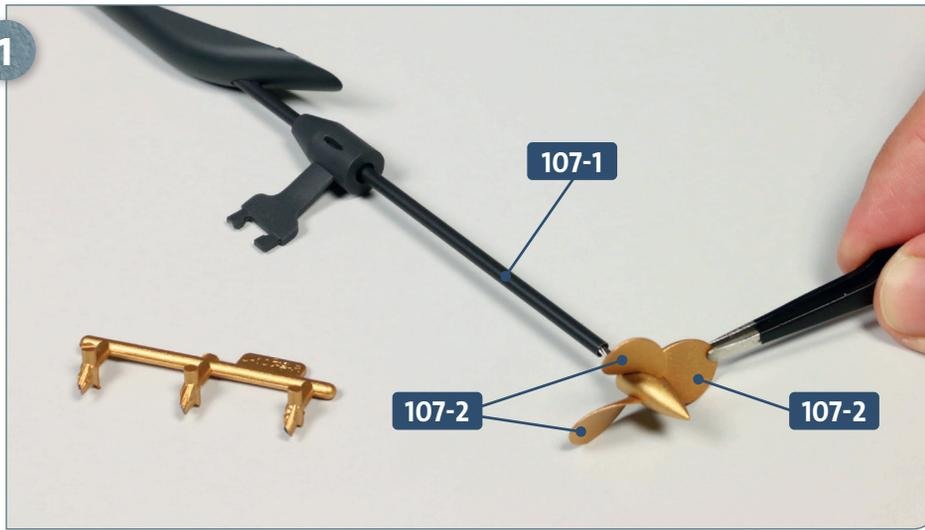
Legen Sie die Propellerwellen-Baugruppe **107-1** bereit. Trennen Sie die drei Propellerblätter **107-2** von den Stegen des Rahmens. Kleben Sie die drei Propellerblätter mit etwas Sekundenkleber in den Schlitzen der Propellernabe von **107-1** fest.
