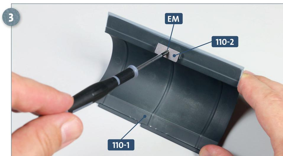
Befestigen Sie die Metallplatte **110-2** mit der Schraube **EM** am Rumpfabschnitt **110-1**.
