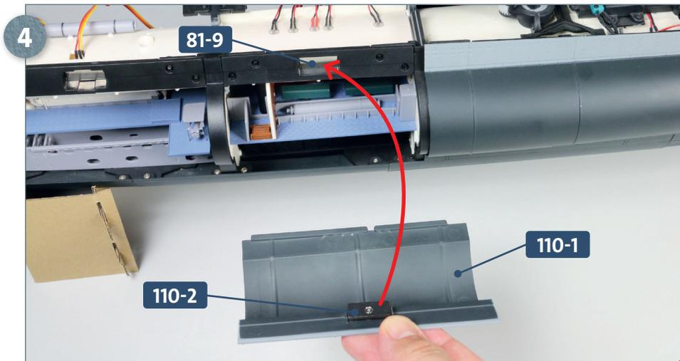
Stellen Sie die Rumpfstruktur so auf Ihre Arbeitsplatte, dass Sie Zugriff auf deren rechte Seite haben. Führen Sie den Rumpfabschnitt **110-1** zur Öffnung der vierten Sektion. Die Metallplatte **110-2** gehört auf den Magnet **81-9**, wie es der Pfeil andeutet.
