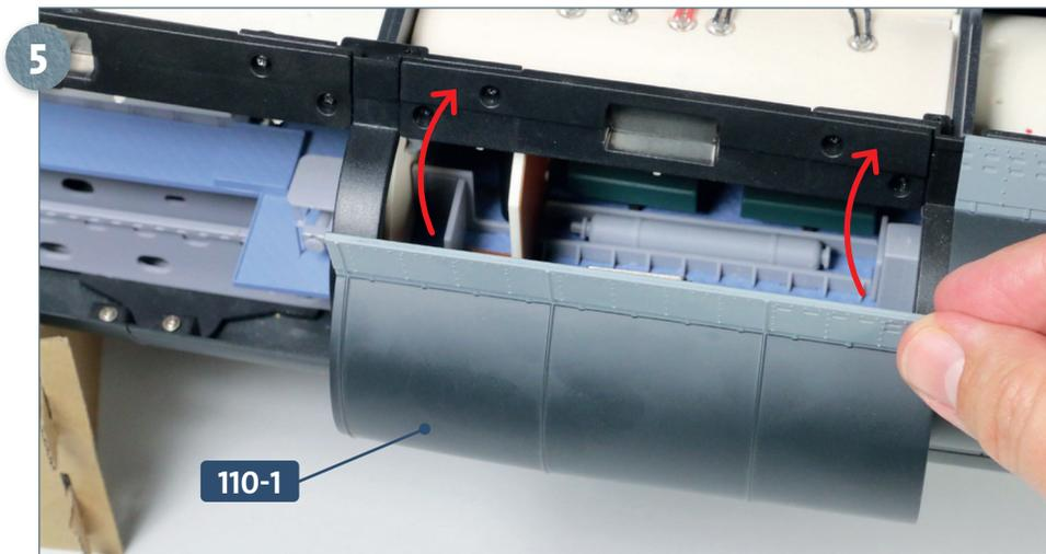
Platzieren Sie die Lippe unten am Rumpfabschnitt **110-1** auf der Kante des Kielteils unter der vierten Sektion und kippen Sie den Rumpfabschnitt nach oben.
