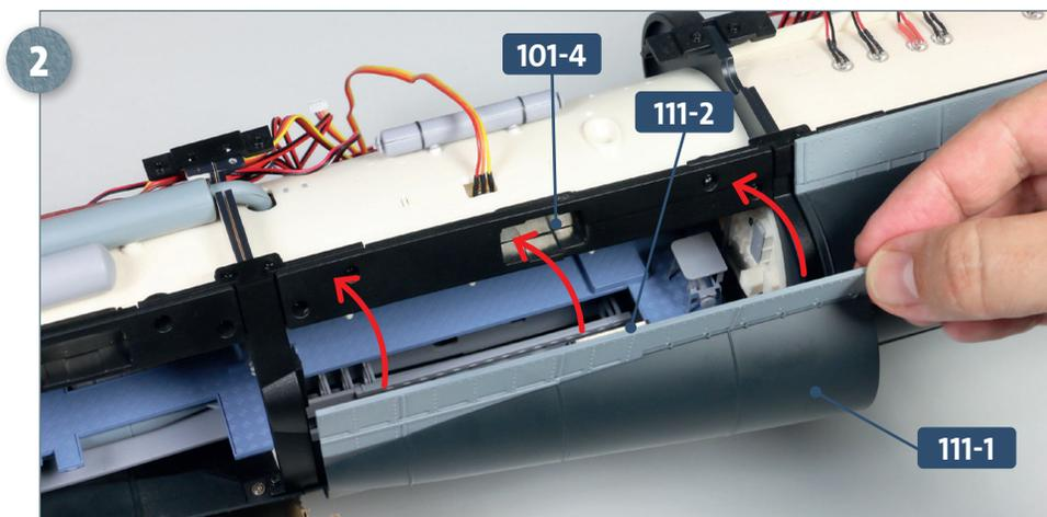
Stellen Sie die Rumpfstruktur so auf Ihre Arbeitsplatte, dass Sie Zugriff auf deren rechte Seite haben. Platzieren Sie die Lippe unten am Rumpfabschnitt **111-1** auf der Kante des Kielteils unter der fünften Sektion. Kippen Sie **111-1** so nach oben, dass die Metallplatte **111-2** am Magnet **101-4** sitzt, wie es der mittlere Pfeil andeutet.
