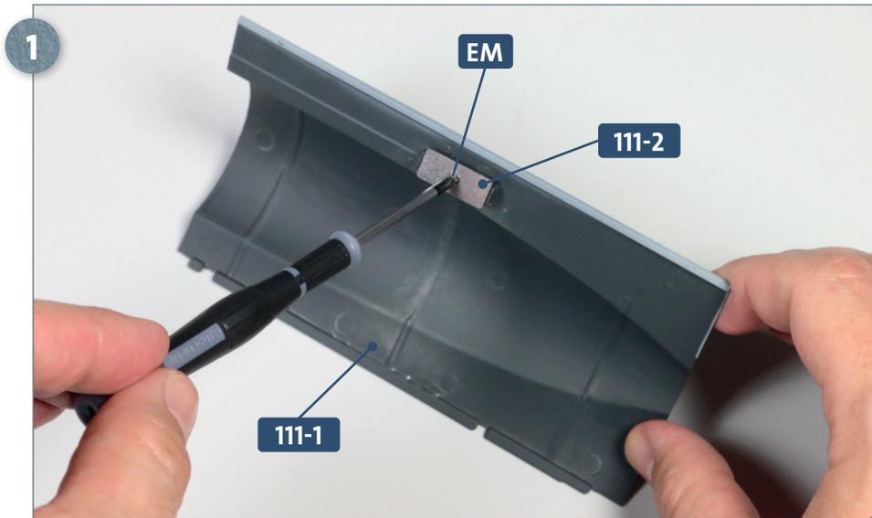
Legen Sie den Rumpfabschnitt **111-1** mit der Innenseite nach oben auf Ihre Arbeitsplatte. Nehmen Sie die Metallplatte **111-2**, setzen Sie sie bündig auf die Bohrung im Rumpfabschnitt und befestigen Sie sie mit einer Schraube **EM**, wie abgebildet.
