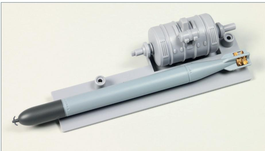
An der Bodenplatte sind ein Torpedo und der Backbord-E-Motor angebracht.
