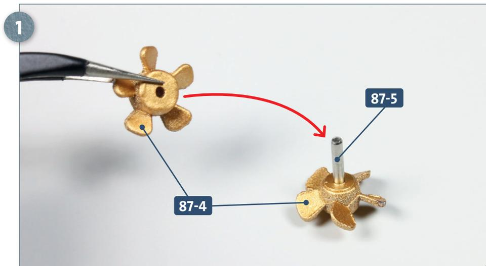
Trennen Sie die beiden gegenläufigen Schrauben aus dem Rahmen **87-4**. Verbinden Sie die beiden Schrauben mithilfe der Welle **87-5** zu einem Propeller, wie abgebildet.
