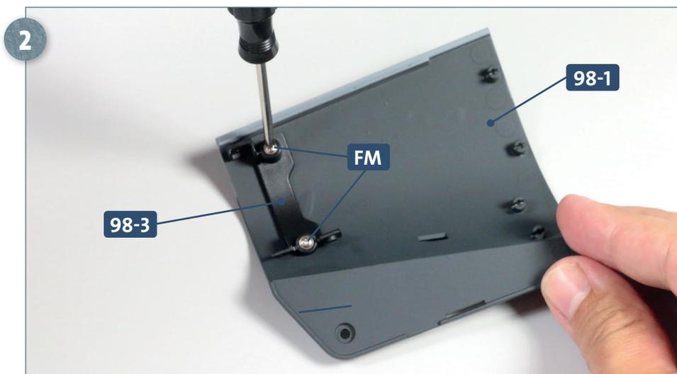
Befestigen Sie den Verbinder **98-3** am Rumpfabschnitt **98-1**, indem Sie die beiden Schrauben **FM** eindrehen.
