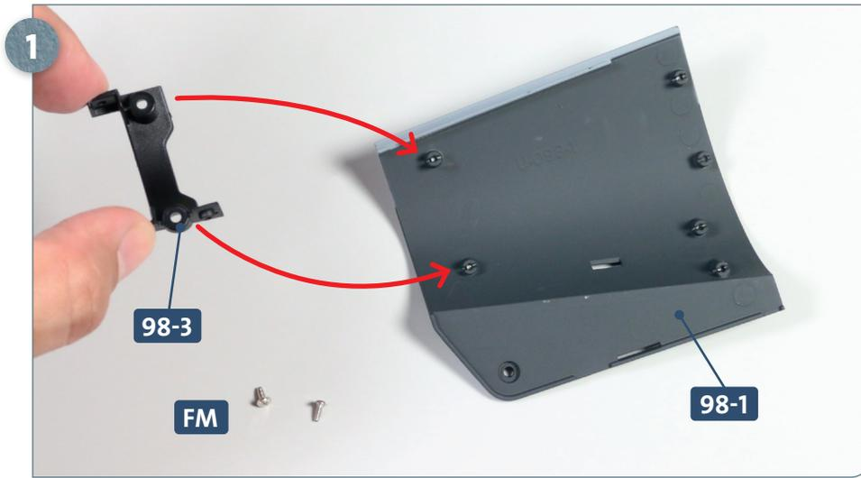
Legen Sie den linken Rumpfabschnitt **98-1** und zwei Schrauben **FM** auf Ihre Arbeitsplatte. Nehmen Sie den Verbinder **98-3**, richten Sie ihn aus, wie es das Foto zeigt, und platzieren Sie ihn auf den Aufnahmen des Rumpfabschnitts, auf die die beiden Pfeile weisen.
