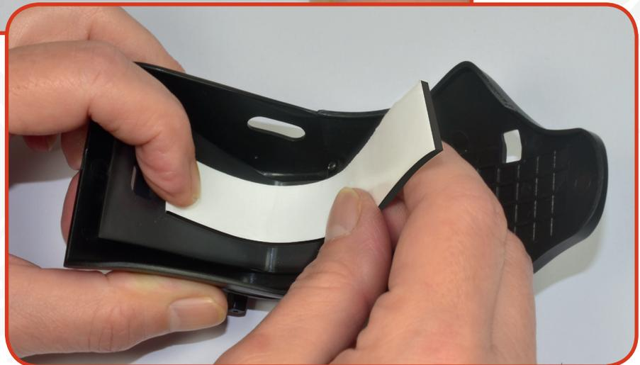
**02** Entfernen Sie die Schutzfolien von einer Seite der doppelseitigen Klebestreifen **39G** und bringen Sie sie entlang der Außenkontur des Sitzrahmens an. Damit sie besser an der Wölbung des Rahmens haften, schneiden Sie sie an den entsprechenden Stellen zu.
