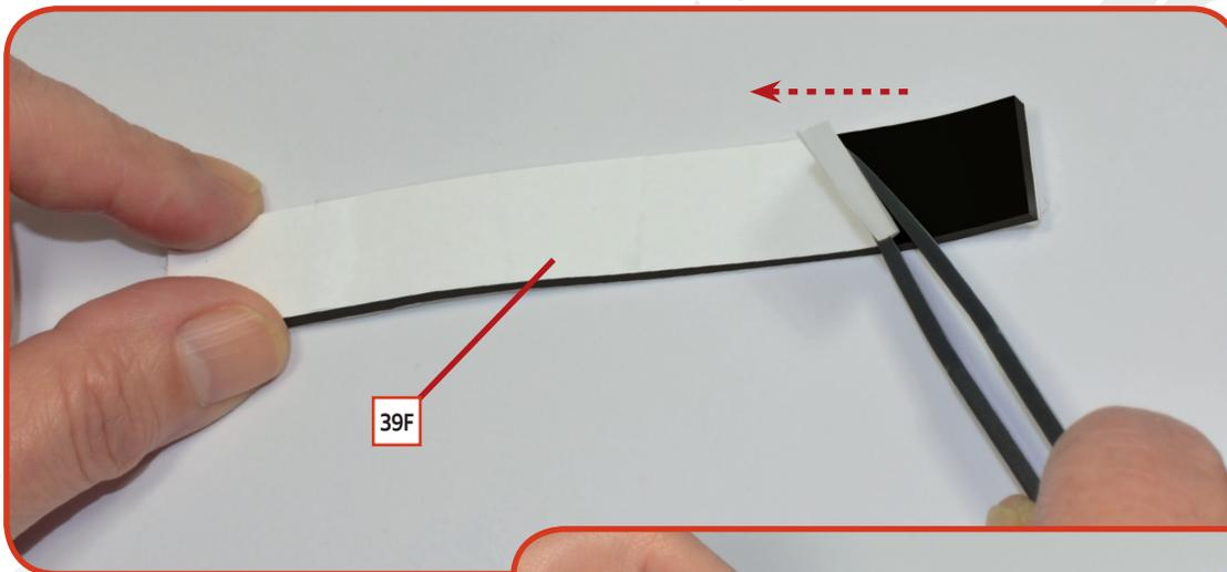
**01** Entfernen Sie die Schutzfolie von einer Seite des breiten doppelseitigen Klebestreifens **39F** und kleben Sie ihn wie abgebildet auf die Mitte des Sitzrahmens, den Sie in Bauphase 38 zusammengesetzt haben.
