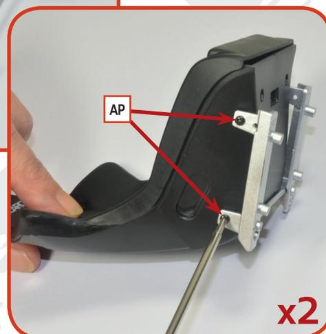
**04** Stecken Sie die Stifte der hinteren Querstange **39D** in die entsprechenden Löcher der Halterungen **39B** und **39C** und richten Sie sie dabei wie auf dem ersten Foto gezeigt aus. Montieren Sie anschließend die Sitzbaugruppe auf die Halterungen und befestigen Sie alles mit vier **AP**-Schrauben (zwei pro Halterung).
