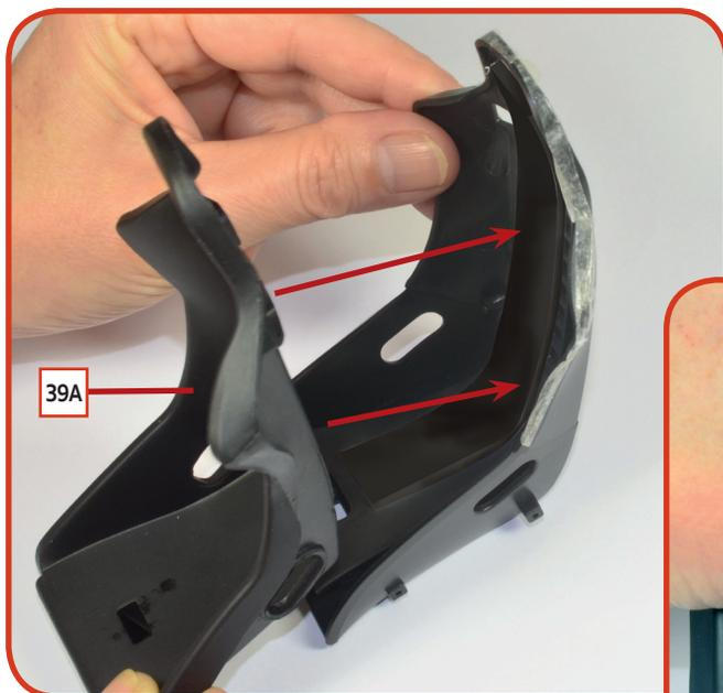
**03** Entfernen Sie die Schutzfolien von den freien Seiten aller doppelseitigen Klebestreifen und befestigen Sie den Sitz **39A** in seinem Rahmen. Üben Sie einen leichten Druck auf die gesamte Oberfläche des Sitzes aus, damit er perfekt sitzt.
