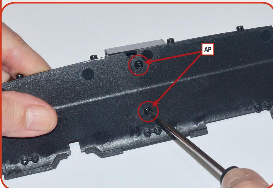
**01** Montieren Sie den Belüftungskanal **59C** an der Außenseite des Panels **59A**, indem Sie die Bauteile wie gezeigt ausrichten und die gebohrten Stifte des Kanals in die mittleren Löcher der Platte einführen. Befestigen Sie die Teile mit zwei Schrauben **AP**.
