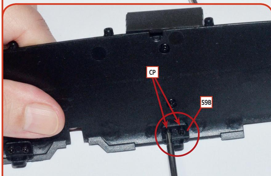
**02** Setzen Sie die drei Halterungen **59B** an den jeweils vorgesehenen Stellen am Innenprofil des Panels ein und befestigen Sie sie mit sechs Schrauben **CP** (zwei pro Halterung).
