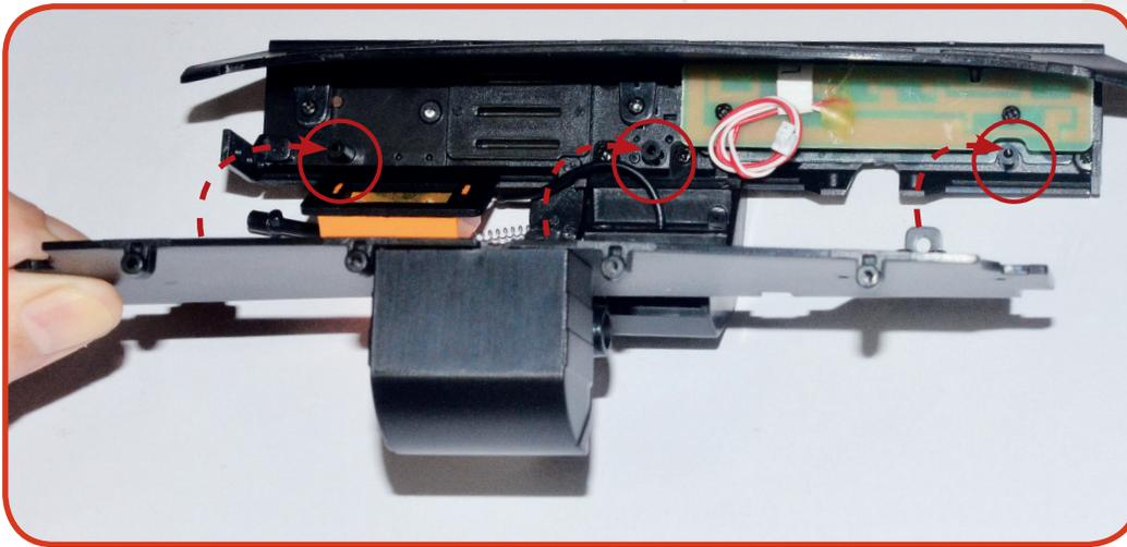
**03** Nehmen Sie das Armaturenbrett Ihres Modells zur Hand und bauen Sie das untere Panel wie abgebildet ein. Richten Sie die Löcher in den Halterungen des Panels an den gebohrten Stiften auf dem Armaturenbrett aus.
