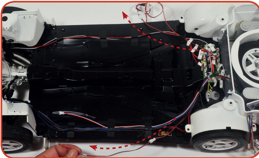
**04** Nehmen Sie die Bodenplatte Ihres Modells zur Hand und legen Sie die Enden der mit „L“, „M“ (es gibt zwei, eines auf jeder Seite) und „N“ gekennzeichneten Kabel wie gezeigt neben die Bodenplatte.
