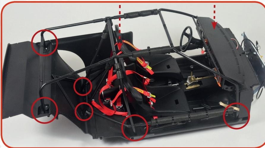
**02** Nehmen Sie jetzt den Überrollkäfig zur Hand, den Sie in den vorangegangenen Bauphasen zusammengebaut haben. Bringen Sie ihn an der Bodenplatte des Innenraums an, indem Sie die Endstücke in die entsprechenden Vertiefungen stecken.
