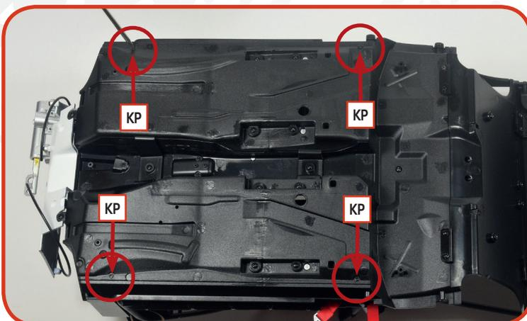
**03** Befestigen Sie die Teile aneinander, indem Sie vier **KP**-Schrauben in den markierten Löchern an der Unterseite der Bodenplatte anziehen.
