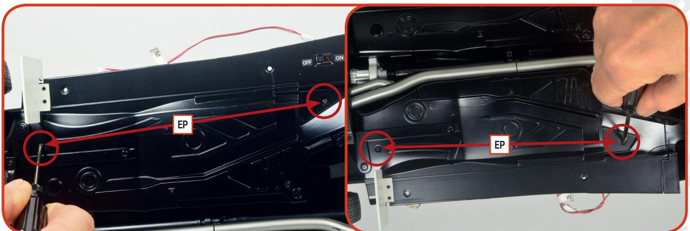
**06** Befestigen Sie den Boden des Innenraums an der Bodenplatte, indem Sie vier EP-Schrauben in den markierten Löchern an der Unterseite der Baugruppe anziehen.
