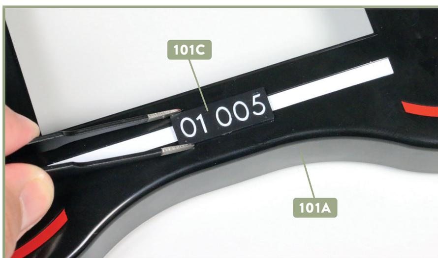
**5** Das Schild mit der Loknummer **101C** ist unten am Vorderteil der Fernbedienung **101A** festgeklebt.
