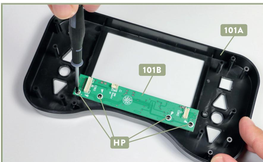
**3** Fixieren Sie die Platine **101B** am Vorderteil der Fernbedienung **101A**, indem Sie die vier Schrauben **HP** eindrehen.
