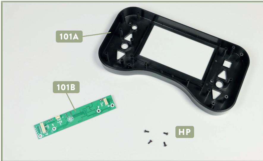
**1** Legen Sie das Vorderteil der Fernbedienung **101A** mit der Innenseite nach oben auf Ihre Arbeitsplatte. Platzieren Sie daneben die Platine **101B** und vier Schrauben **HP**, wie abgebildet.
