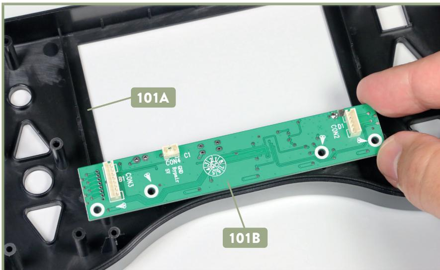
**2** Richten Sie die Platine **101B** so aus, wie es das Foto zeigt, und setzen Sie sie unten mittig in das Vorderteil der Fernbedienung **101A** ein.
