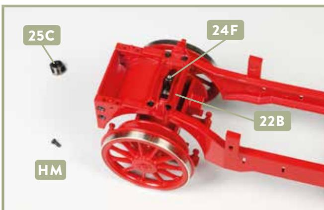
**5** Der Drehzapfen **24F** vom Nachlaufbausatz sitzt in der länglichen Bohrung der Querverbindung **22B**. Legen Sie die hintere Aufnahme **25C** und eine Schraube **HM** bereit.
