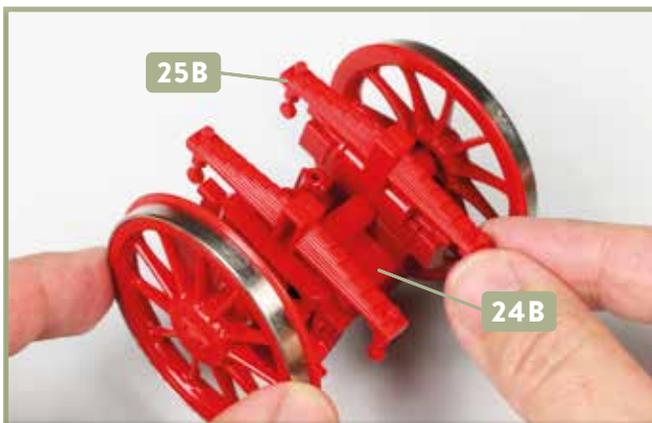
**3** Wechsel ans rechte Ende der Unterseite vom Achslagergehäuse **24B**: Befestigen Sie hier die rechte Blattfeder **25B**. Drücken Sie dazu wieder die Zapfen in die entsprechenden Aufnahmen hinein.
