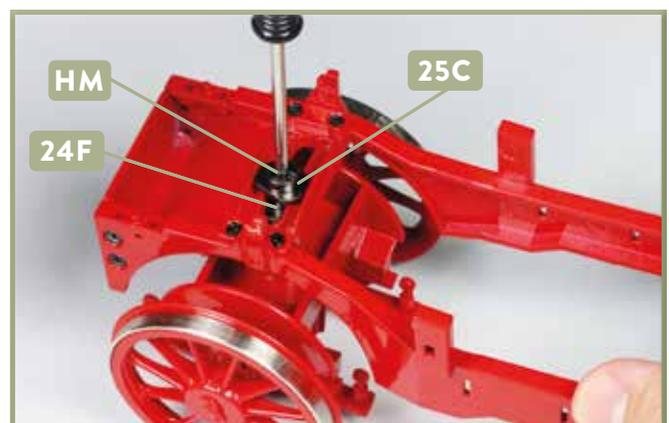
**6** Setzen Sie die hintere Aufnahme **25C** auf das obere Ende des Drehzapfens **24F** und fixieren Sie diese mit der Schraube **HM**. Der Nachlaufbausatz ist nun beweglich mit dem Rahmen verbunden.
