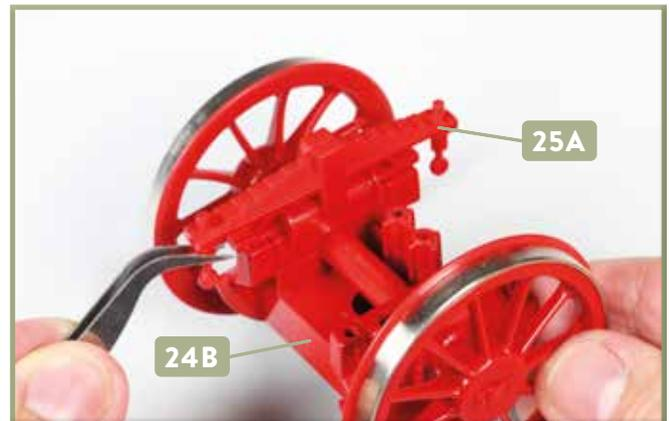
**2** Befestigen Sie die linke Blattfeder **25A** am Achslagergehäuse **24B**, indem Sie deren zwei Zapfen vorsichtig in die entsprechenden Bohrungen hineindrücken.
