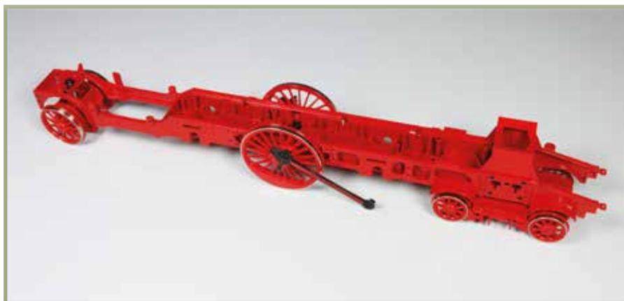
Der Nachlaufwagensatz und das Drehgestell sind mit dem Barrenrahmen der Lokomotive verbunden.
