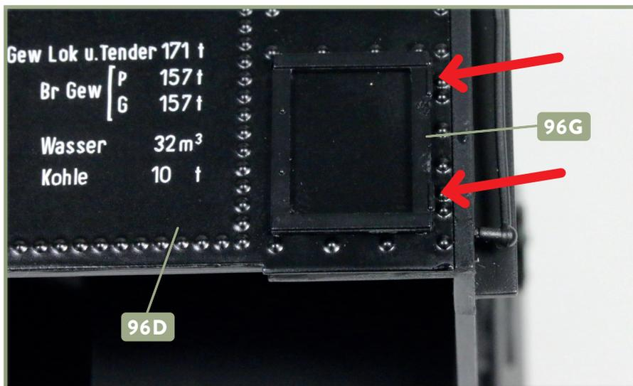
**11** Versetzen Sie die vier Zapfen des Rahmens **96G** mit etwas Sekundenkleber und fügen Sie diese in die entsprechenden Löcher im Seitenblech **96D** ein. Achten Sie wieder auf die Ausrichtung des Rahmens: Seine beiden Auswüchse, auf die die Pfeile weisen, befinden sich auf der rechten Seite.
