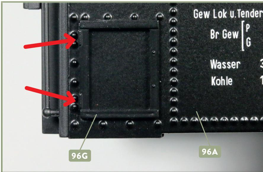
**7** Der Rahmen für Wagenzettel **96G** ist am Seitenblech **96A** fixiert. Achten Sie auf die Ausrichtung des Rahmens: Seine beiden Auswüchse befinden sich auf der linken Seite (die Pfeile weisen auf die Stellen).
