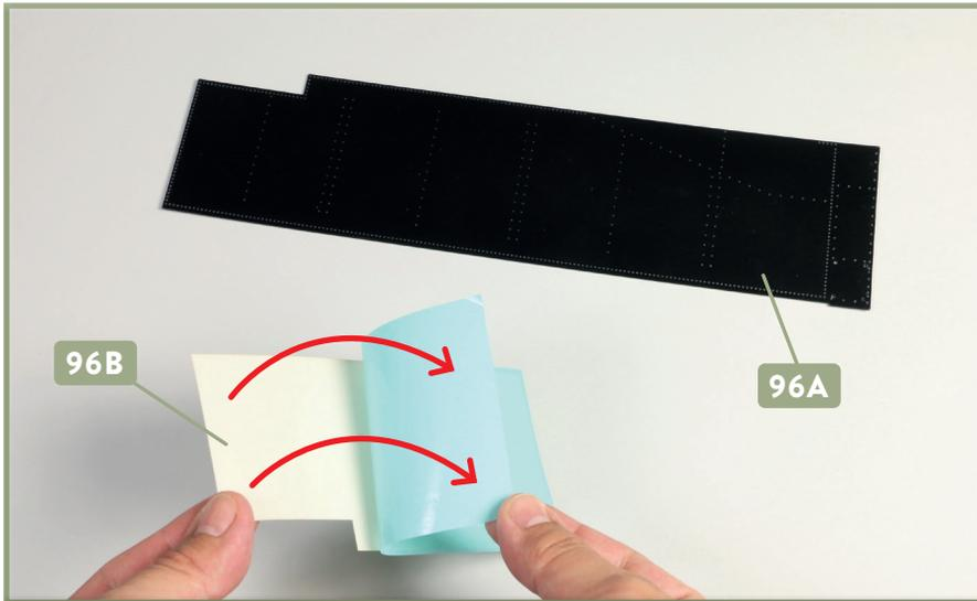
**1** Legen Sie das linke Seitenblech **96A** mit der Außenseite nach unten auf Ihre Arbeitsplatte: Die Beschriftung auf dem Teil ist somit nicht zu sehen. Nehmen Sie die doppelseitige Klebefolie **96B** und entfernen Sie die bläuliche Trägerfolie, wie angedeutet.
