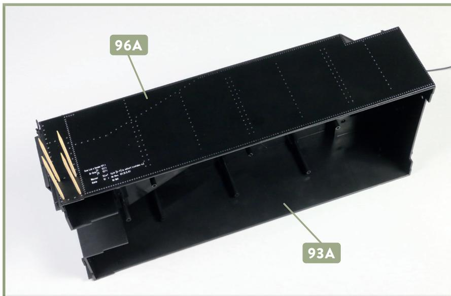
**5** Um das Seitenblech **96A** ganz exakt auf dem Tender-Behälter **93A** anzubringen, empfehlen wir, zuvor Zahnstocher in die vier Löcher links unten auf dem Seitenteil zu stecken. Die Spitzen der Zahnstocher führen Sie dann zu den entsprechenden Löchern im Behälter und drücken das Seitenteil von vorne nach hinten fest an.
