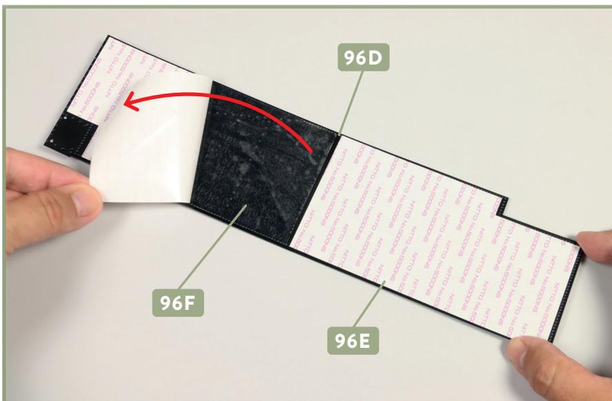
**9** Lösen Sie die bläuliche Trägerfolie von den Klebefolien **96E** und **96F** und bringen Sie diese auf dem Seitenblech **96D** an. Anschließend werden von beiden Klebefolien die weißen Trägerpappen entfernt.
