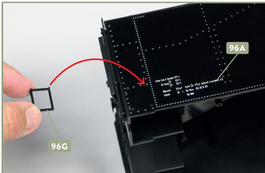
**6** Nehmen Sie einen der beiden Rahmen für Wagenzettel **96G** und versehen Sie dessen vier Zapfen mit etwas Sekundenkleber. Führen Sie den Rahmen zu den Löchern, die sich links unten im Seitenblech **96A** befinden.
