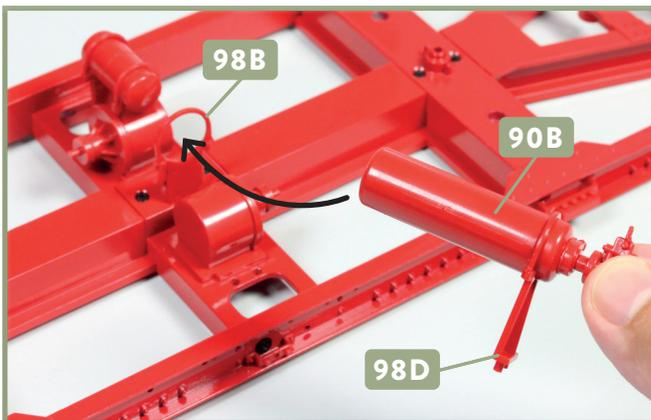
**5** Führen Sie das freie Ende des Luftbehälters **90B** durch die Schelle **98B**, wie es der Pfeil andeutet.
