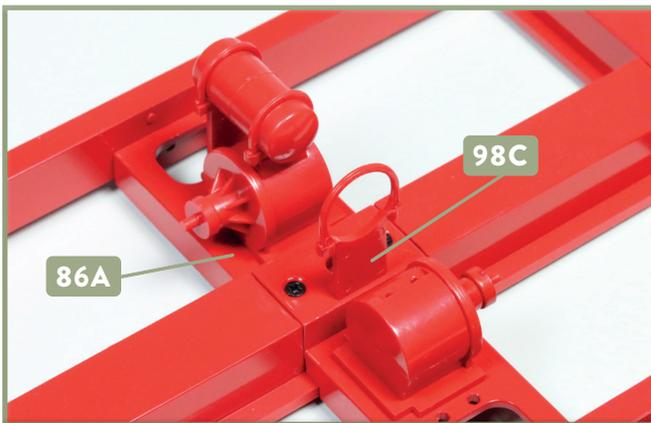
**3** Die Halterung **98C** ist mittig zwischen den beiden Bremszylindern auf dem Querträger **86A** fixiert.
