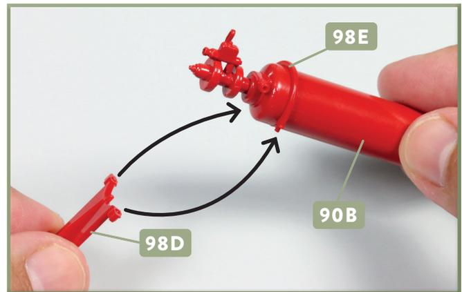
**4** Versehen Sie den Zapfen, der sich mittig an der Schelle **98E** befindet, mit Sekundenkleber und fixieren Sie das Teil am Luftbehälter **90B**. An den äußeren Zapfen der Schelle wird die Halterung **98D** festgeklebt, wie es die Pfeile andeuten.
