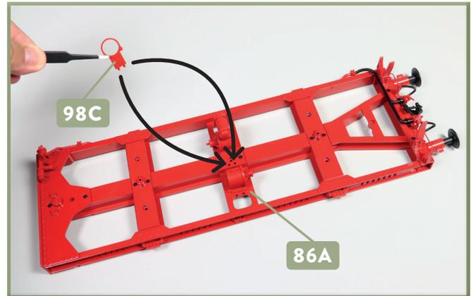
**2** Legen Sie den Tenderrahmen mit der Unterseite nach oben auf Ihre Arbeitsplatte. Geben Sie etwas Sekundenkleber auf die beiden Zapfen der Halterung **98C** und fügen Sie diese in die Bohrungen des Querträgers **86A** ein, auf die die Pfeile weisen.
