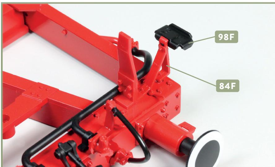
**7** Sprung ans hintere Ende des Tenderrahmens: Kleben Sie eines der Trittbleche 98F an der linken Befestigung 84F fest, wie es das Foto zeigt.
