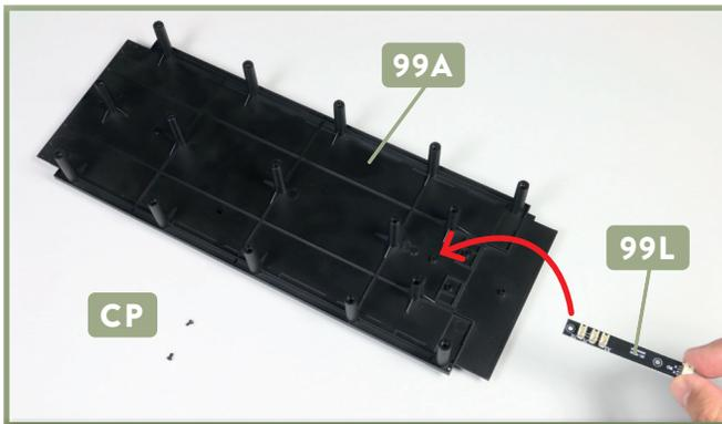
**1** Legen Sie die Bodenplatte des Tenders **99A** und zwei Schrauben **CP** auf Ihre Arbeitsplatte. Nehmen Sie die Platine **99L** und führen Sie sie zu den Aufnahmen am vorderen Ende der Bodenplatte.
