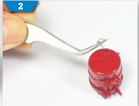
**2** Stecken Sie den Verschluss in das Loch im oberen Bereich des Öltanks.
