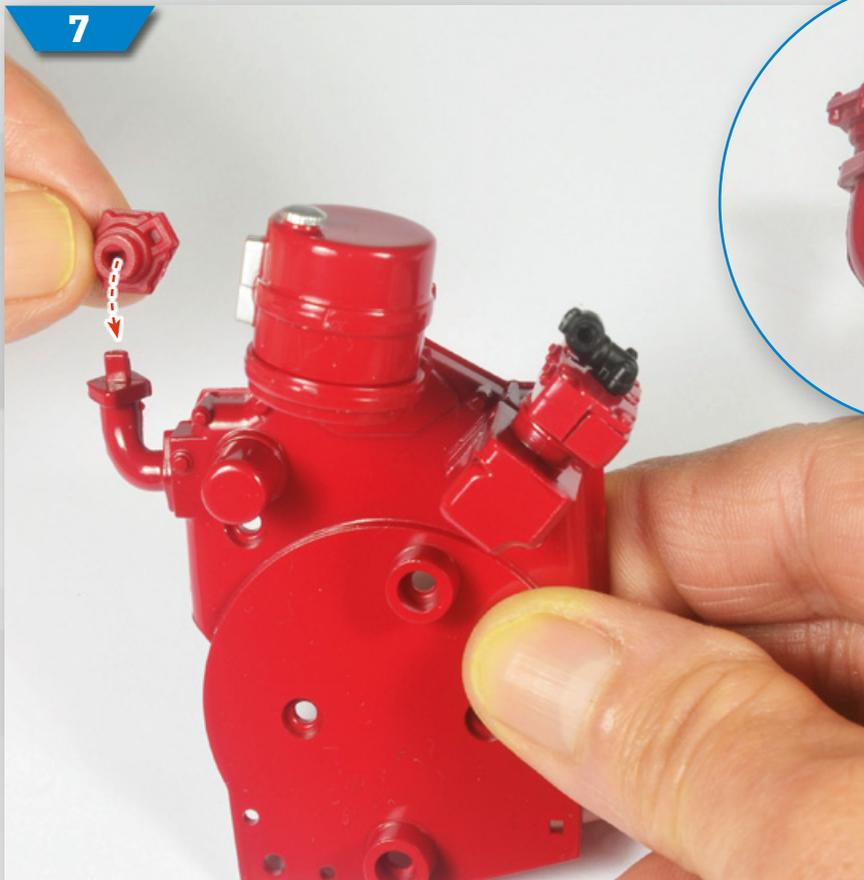
**7** Installieren Sie das Ventil an dem Ende des Rohrs, das aus der Motorrückwand herausragt, wie auf dem Foto gezeigt.
