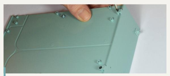
112-4. Überprüfen Sie, ob die Teile korrekt aneinander ausgerichtet sind und ziehen Sie die beiden Schrauben aus Schritt 2 und 3 fest an.
