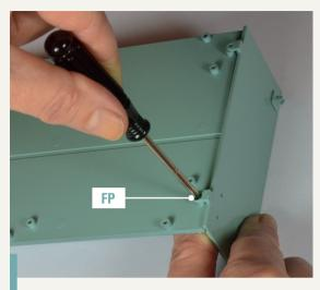
112-2. Beginnen Sie mit der Befestigung der Komponenten, indem Sie eine Schraube FP in das angezeigte Loch einsetzen, ohne sie vollständig festzuziehen.
