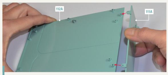
112-1. Nehmen Sie die Vorderwand 111A zur Hand und verbinden Sie sie mit der Bodenplatte 112A. Richten Sie dabei die Teile wie gezeigt aus. Richten Sie die gelochten Zapfen am unteren Profil der Vorderwand an den gelochten Stiften an der Unterseite der Bodenplatte aus.
