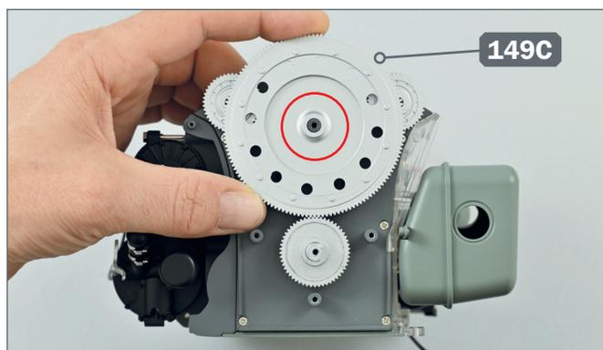
**6** ▶ Stecken Sie das Zahnrad 149C auf den herausstehenden Stift der hinteren Motorplatte über das Lager, das Sie in Schritt 1-5 eingebaut haben. Richten Sie die Teile wie auf dem Foto gezeigt aus.
