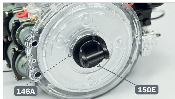
**12** ▶ Montieren Sie die so entstandene Baugruppe an der Vorderseite des Motors, indem Sie die drei Stifte der Innenseite der Platte 150E in die entsprechenden Bohrungen des Schwungrads 146A einsetzen.
