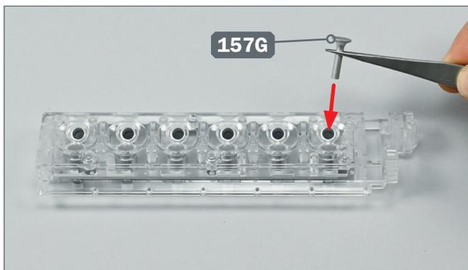
**3** ► Drehen Sie die Baugruppe um und setzen Sie an der Außenseite des Motorkopfes ein Tellerventil 157G in eine der Vertiefungen, die sich in Höhe der Stützplatte befinden.
