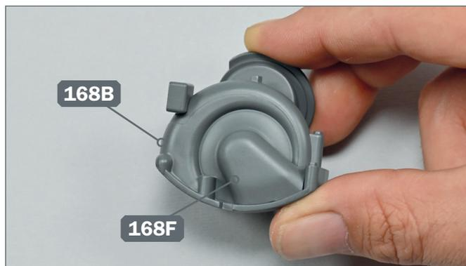
**4** ▶ Installieren Sie die Leitung 168F auf dem Gehäuse der Wasserpumpe 168B und richten Sie die Teile wie auf dem Foto gezeigt aus.
