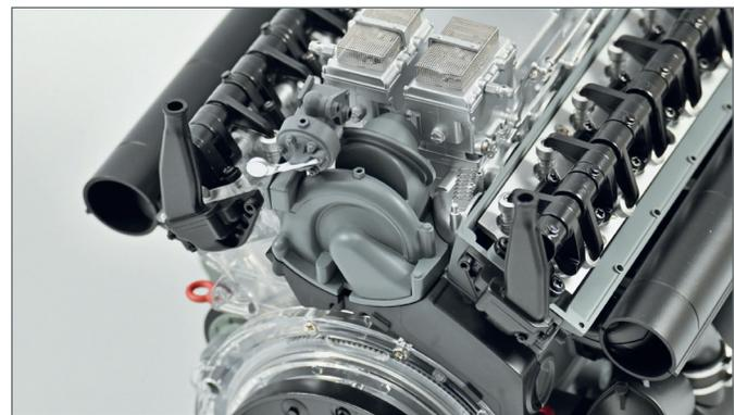
**12** ▶ Installieren Sie die Wasserpumpe auf dem Motor, richten Sie die Teile wie gezeigt aus und passen Sie die in den Schritten 1–10 und 1–11 hervorgehobenen Elemente an.
