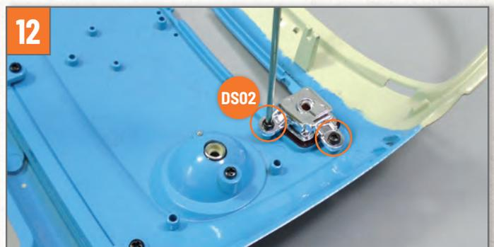
Befestigen Sie das Gehäuse mit zwei Schrauben **DS02** an der Karosserie.
