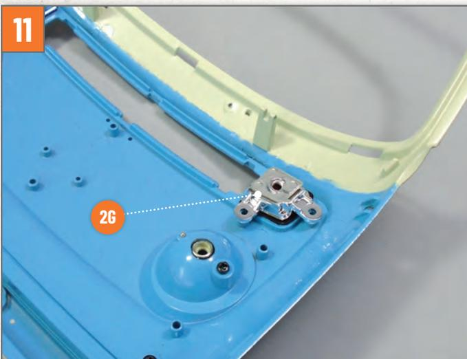
Positionieren Sie analog zu Schritt 8 das rechte Reflektorengehäuse **2G**.
