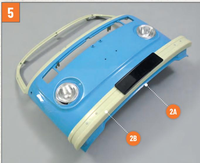
Positionieren Sie die vordere Stoßstange **2B** über der Stoßstangenbasis **2A**.
