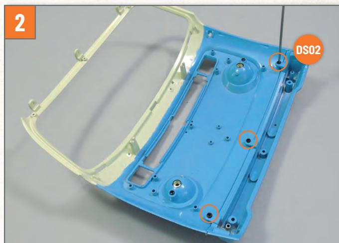
Fixieren Sie die Teile anschließend mit drei Schrauben **DS02**.
