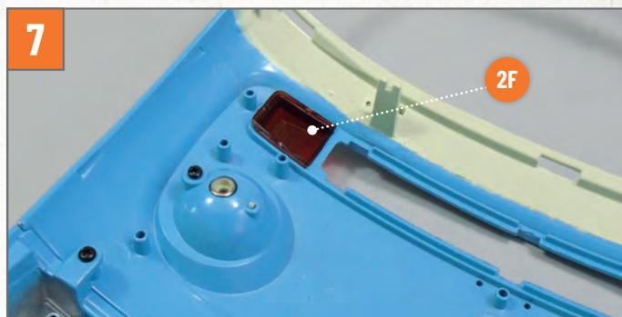
Setzen Sie das linke Blinkerglas **2F** (mit „L1“ gekennzeichnet) von innen in die Aussparung der Karosserie ein.
