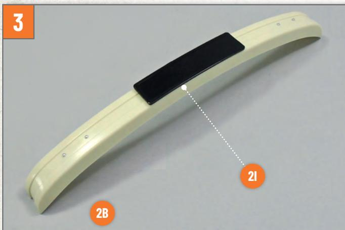
Bringen Sie die vordere Nummernschildhalterung **2I** an der vorderen Stoßstange **2B** an und richten Sie beide Elemente so aus, dass der kleine hintere Vorsprung des ersten in das entsprechende Loch des letzteren eingeführt wird.
