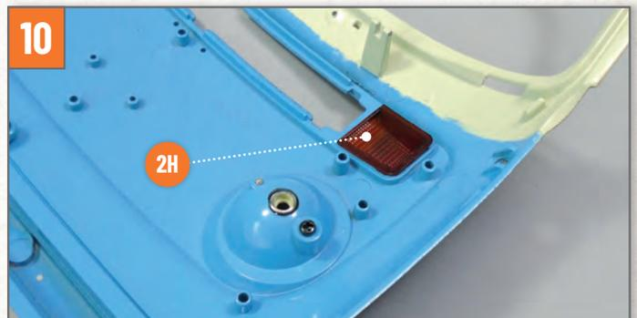
Setzen Sie auf die gleiche Weise das rechte Blinkerglas **2H** (mit „R1“ gekennzeichnet) ein.
